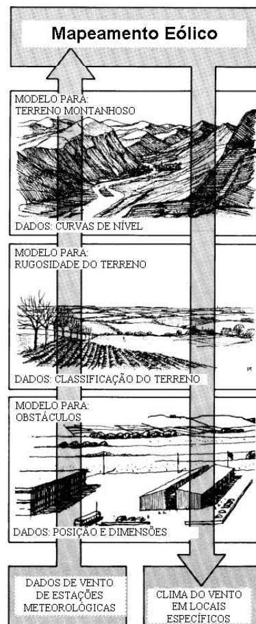
Figura 28. Esquemática de funcionamento do WAsP.
