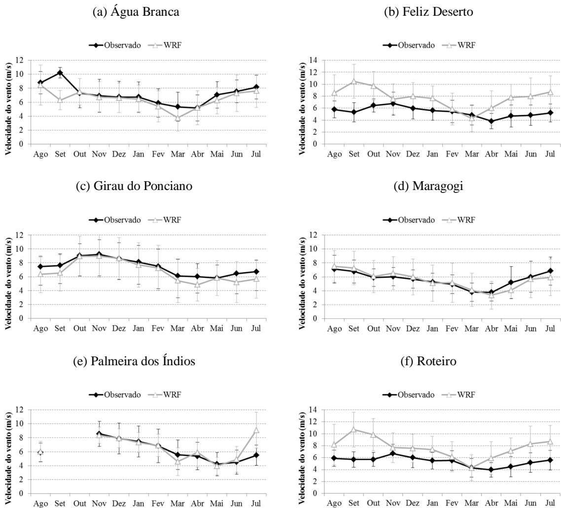
Figura 45. Média mensal e seus respectivos desvios da velocidade do vento observado e estimado pelo WRF.
