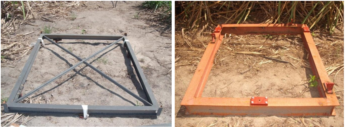
Figura 6. Cantoneiras para fixação das células de cargas.
