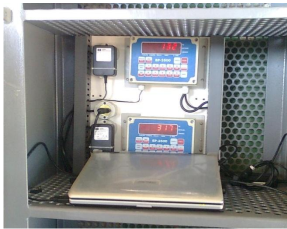
Figura 11. Datalogger utilizado para armazenamento dos dados.
