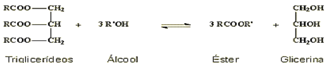
Figura 1 - Reação de transesterificação de triglicéridos com álcool
