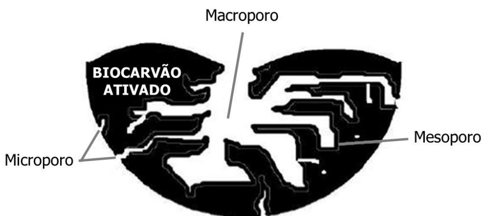
Figura 4 – Estrutura dos poros no carvão ativado.
