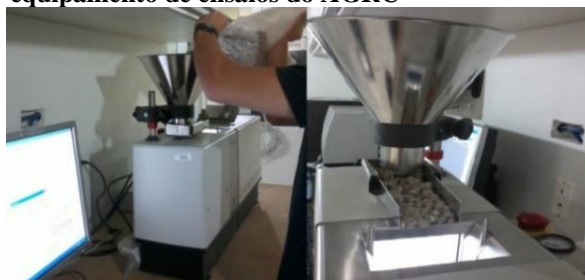
Figura 2.12 - Camsizer-L – equipamento de ensaios do AGRC
