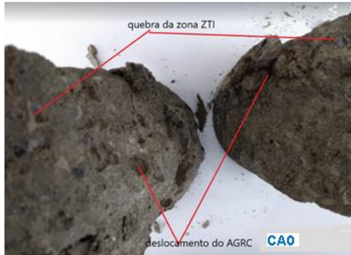
Figura 5. 29 - Forma de ruptura do CA0 com absorção (CAAc/a)
