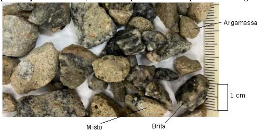
Figura 3.9 – Apresentação do AGRC 12,5 mm usado para a análise do percentual de argamassa presa
