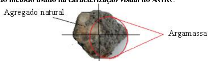
Figura 3.10 - Detalhe do método usado na caracterização visual do AGRC
