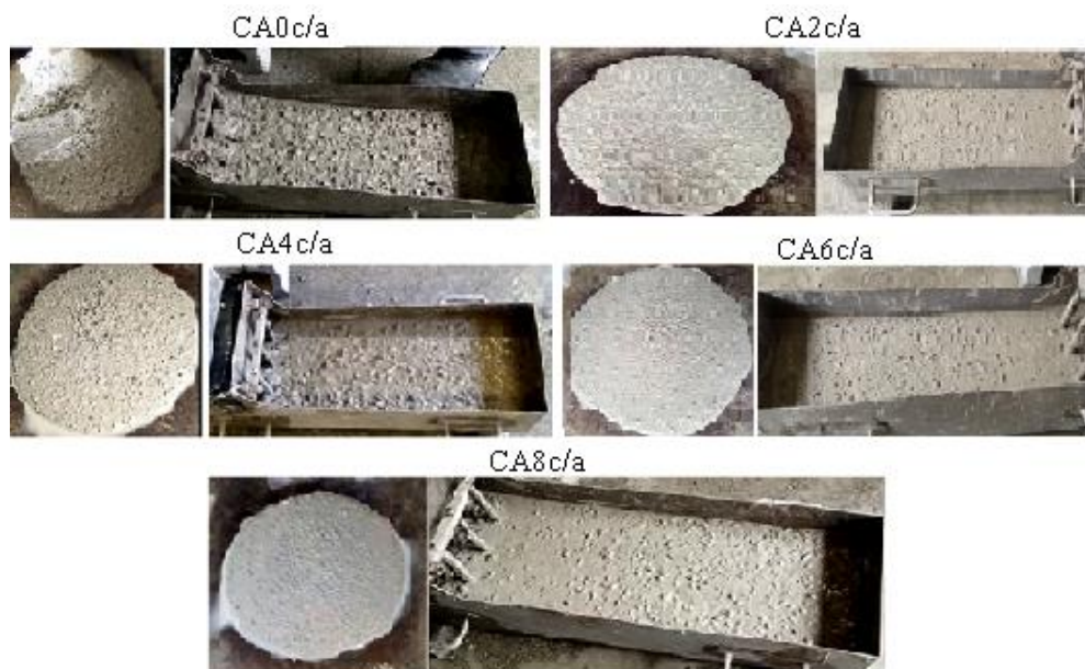
Figura 5. 24 - Ensaios de espalhamento e Caixa - L dos CAAc/a CA6c/a
