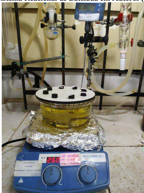
Figura 10 – Sistema Reacional de Batelada em reatores (Vials) de 5 mL
