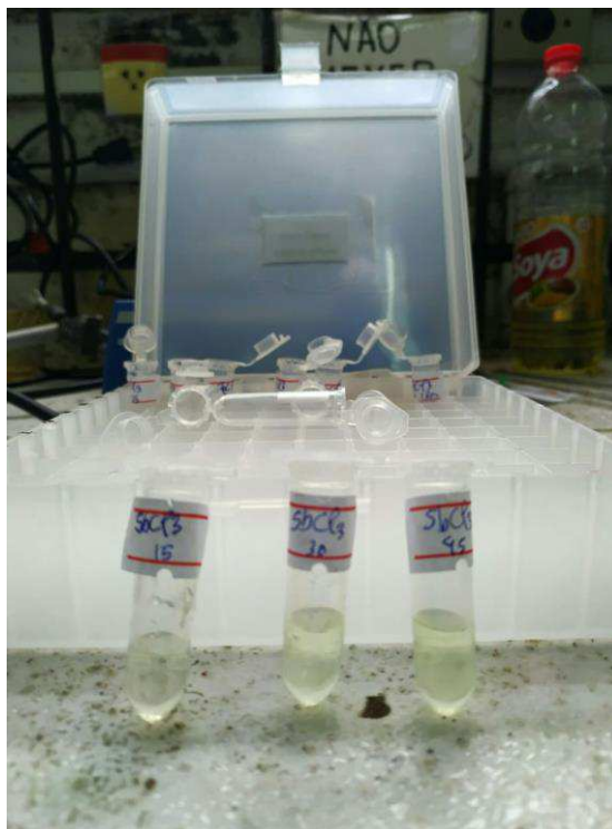
Figura 27 – Mudança de aparência visual das amostras com o avanço do tempo reacional, utilizando o \text{SbCl}_5 . Evidenciando a formação dos produtos.
