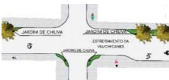
Figura 42 – Esquema ilustrativo da distribuição dos jardins de chuva e exemplificação das chicanes (sem escala).
