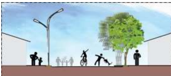
Figura 44 – Esquema ilustrativo do corte transversal das ruas locais (sem escala).
