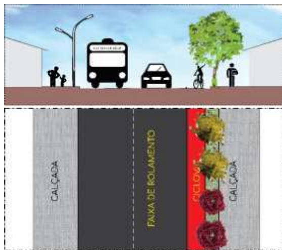
Figura 45 - Esquema ilustrativo da seção transversal da Avenida Belmiro Amorim e Francisco A. de Melo, com duas faixas de rolamento (sem escadas).
