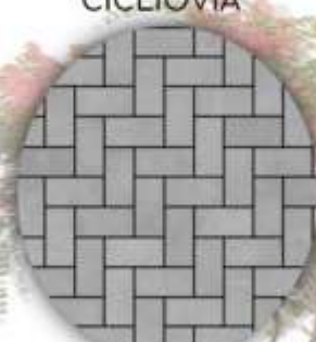
PISO INTERTRAVADO/ CALÇADA
