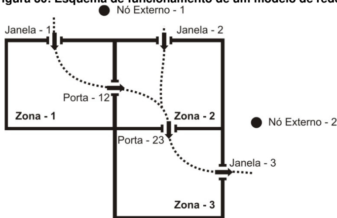
Figura 30: Esquema de funcionamento de um modelo de rede.
