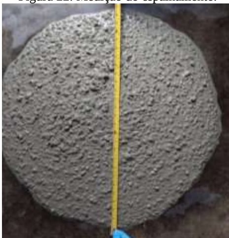
Figura 22: Medição do espalhamento.
