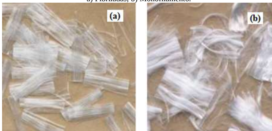
Figura 2: Microfibras poliméricas a) Fibriladas; b) Monofilamento.
