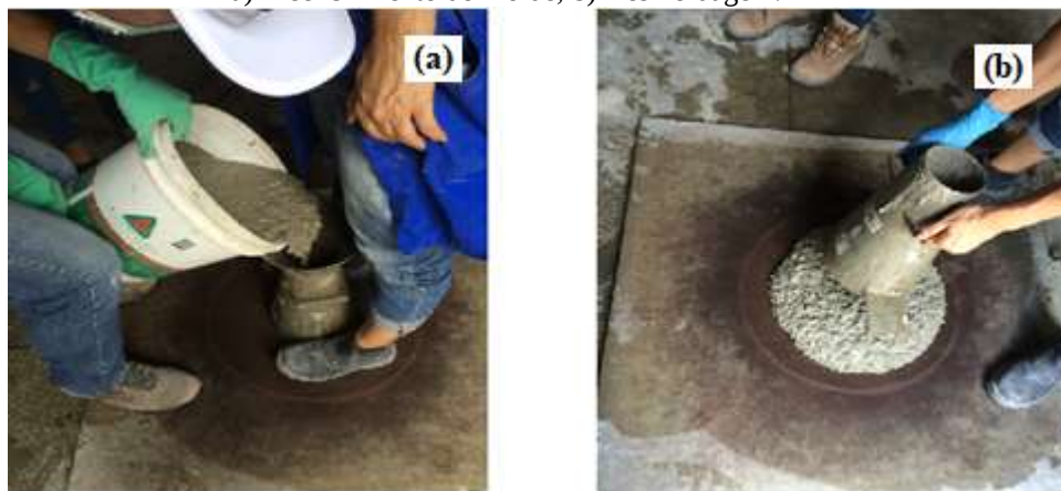
Figura 21: Procedimento de ensaio prático a) Preenchimento do molde; b) Desmoldagem.
