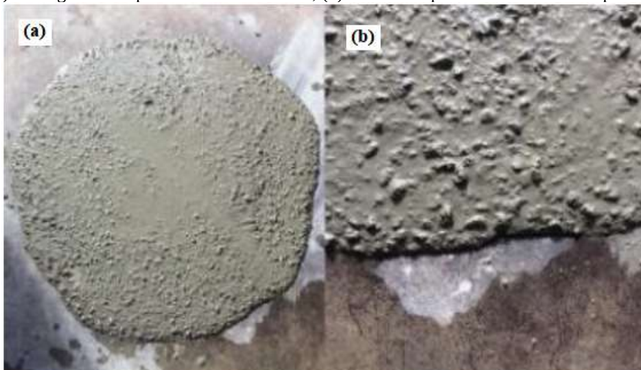
Figura 36: Detalhes do espalhamento da produção 1 do CRFA (a) Vista geral do espalhamento do concreto; (b) Detalhe da periferia do concreto espreado.
