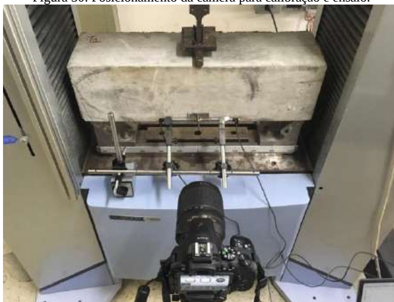
Figura 30: Posicionamento da câmera para calibração e ensaio.
