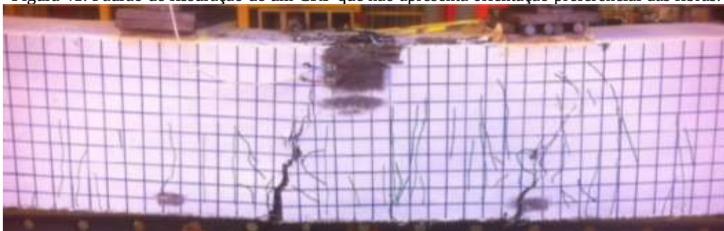
Figura 41: Padrão de fissuração de um CRF que não apresenta orientação preferencial das fibras.
