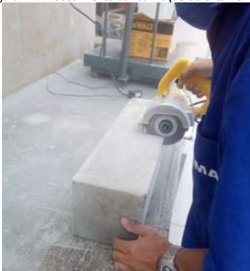
Figura 24: Procedimento da realização do entalhe.
