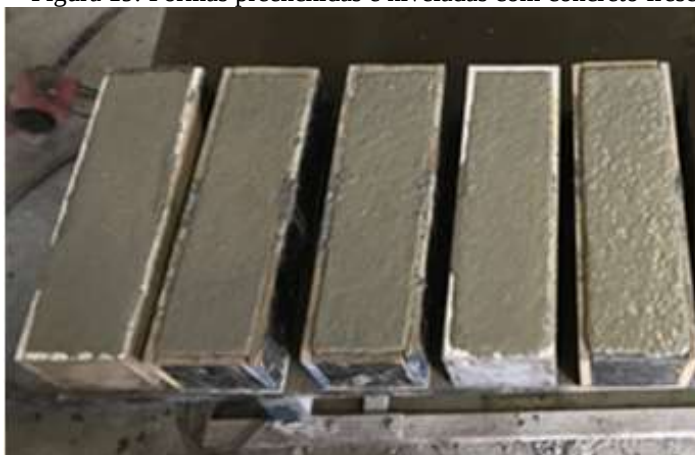
Figura 19: Formas preenchidas e niveladas com concreto fresco.
