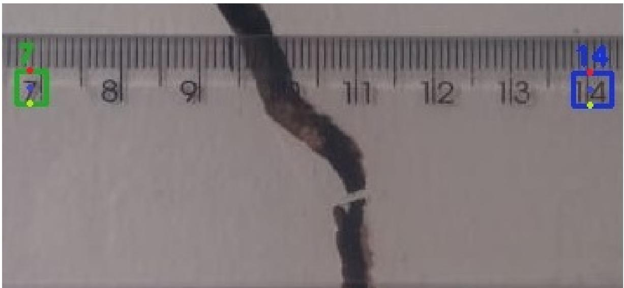
Figura 27 – Marcação dos pontos rastreáveis nos dígitos 7 e 14. Esses pontos representados pelas cores vermelha, azul e amarelo respectivamente são os pontos iniciais e finais que geram um caminho para aplicar o algoritmo Bresenham.
