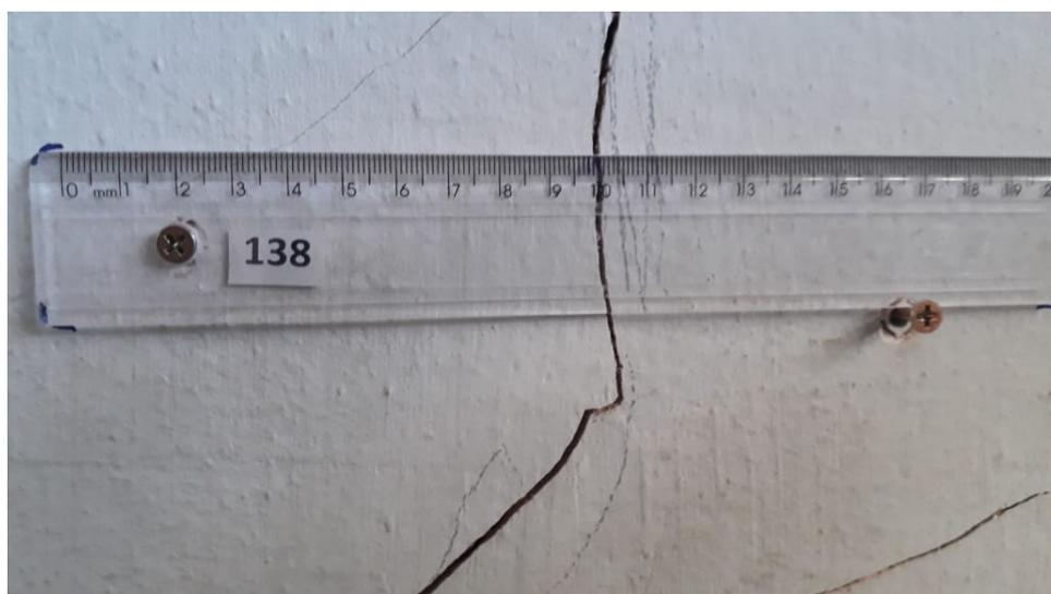
Figura 20 – Exemplo de régua instalada em uma das casas
