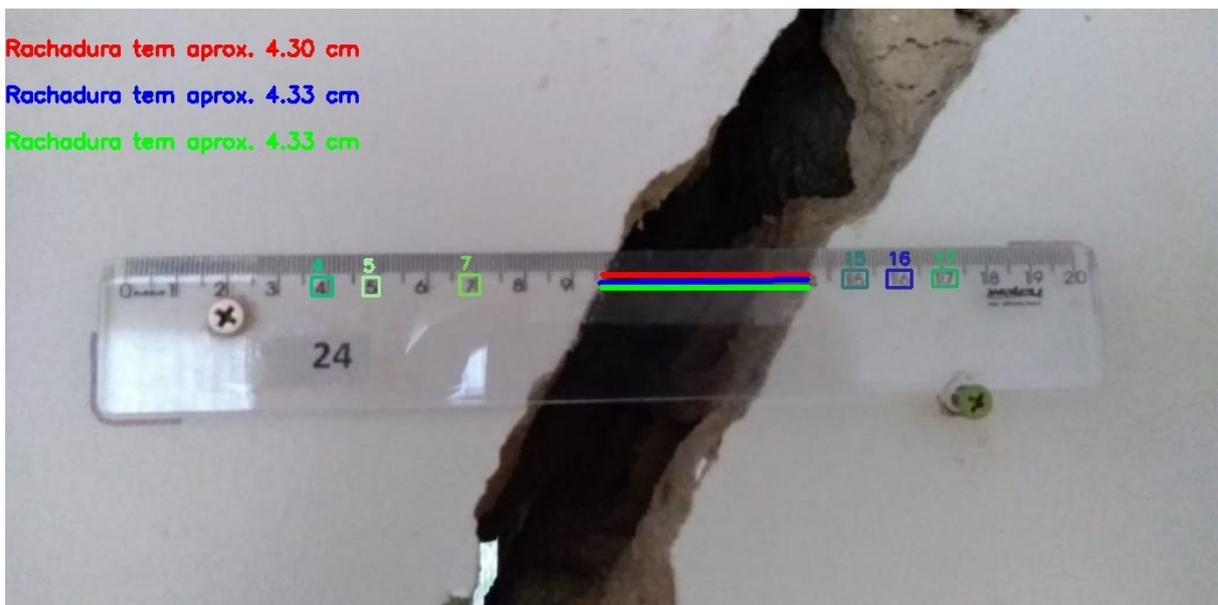
Figura 58 – **Sexta etapa:** é realizado a execução dos valores correspondentes da rachadura encontrada através do caminho traçado pelo algoritmo de Bresenham
