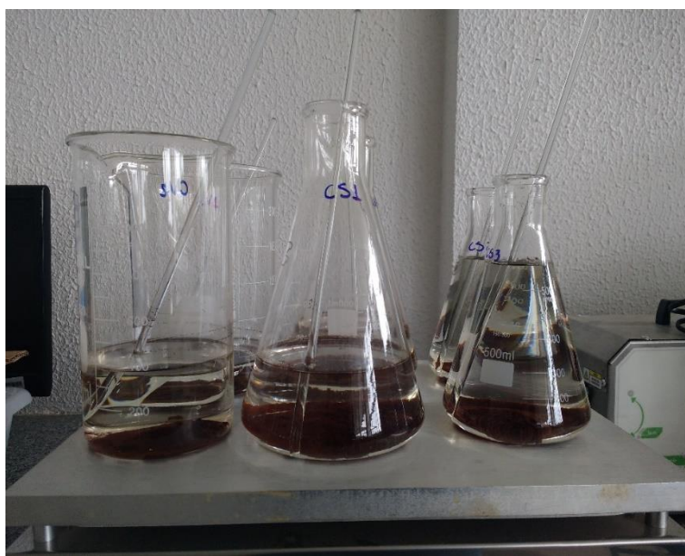
Figura 1. Procedimento de fervura da lignina em chapa aquecedora.
