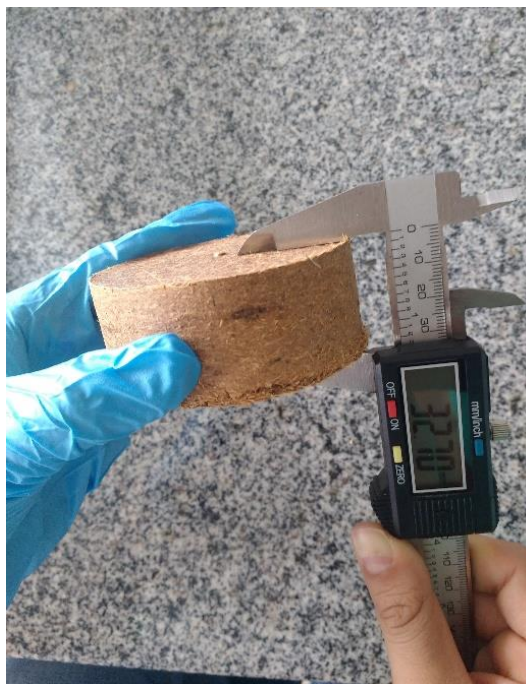
Figura 4. Determinação da altura dos briquetes por meio de paquímetro digital.
