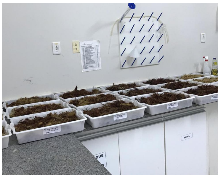
Figura 4. Instalação física do ensaio de incubação de cascas de coco seco.
