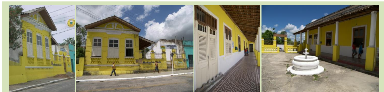
Quadro 13 – Antiga habitação estilo eclético – Chalé – com nítidas preocupações de adequação climática: esquadrias grandes e vazadas, alpendre lateral voltado para onde antes se tinha o jardim. Fonte: Gabriella Peixoto, 2009.
