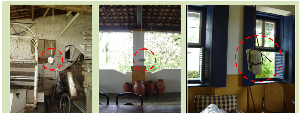
Quadro 6 – Colocação dos equipamentos de medição nos ambientes, da esquerda para a direita: Ponto externo com Hobo® protegido pelo recipiente de alumínio; Ponto na varanda e ponto no interior da casa. Fonte: Gabriella Peixoto, 2008.
