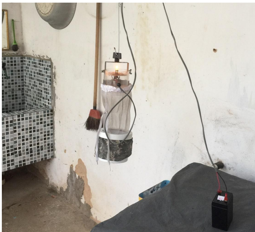
Figura 4. CDC-luminosa armada no quintal (peridomicílio) da residência em Maceió – AL.
