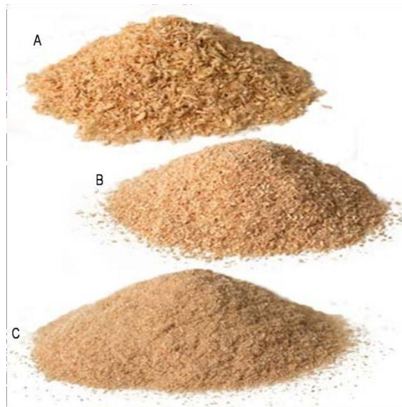
Figura 18: Resíduos madeireiros: A – Maravalha; B – Serragem grossa; C – Serragem fina
