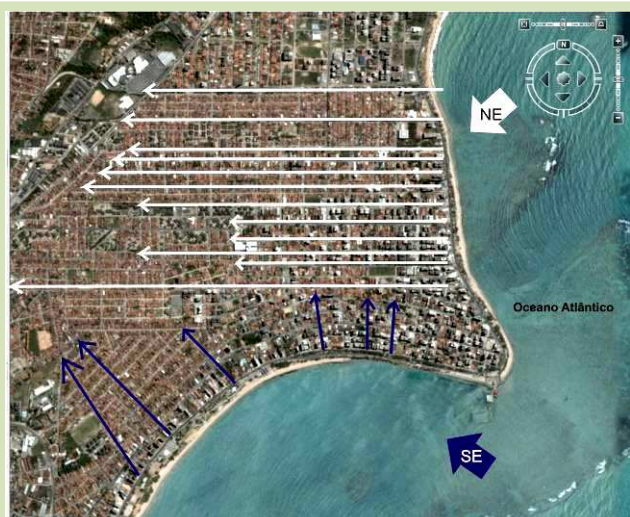
Ilustração 80: Penetração dos ventos predominantes na malha urbana da planície litorânea, com a criação de corredores de ventilação através das vias. Fonte: Produzido a partir de imagem do Google earth.
