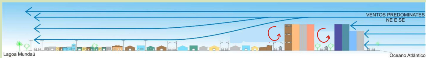
Ilustração 83: Perfil esquemático de Maceió Nº 1 com demonstração do padrão de ventilação na região da planície.
