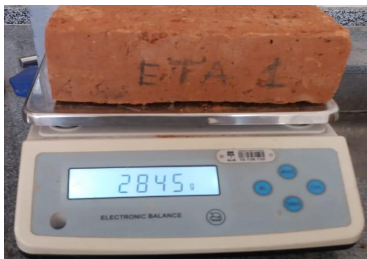
IMAGEM 36: Pesagem do tijolo após retirada da estufa
