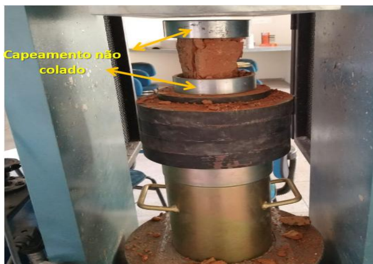
IMAGEM 35: Rompimento de corpo de prova com uso de capeamento não colado
