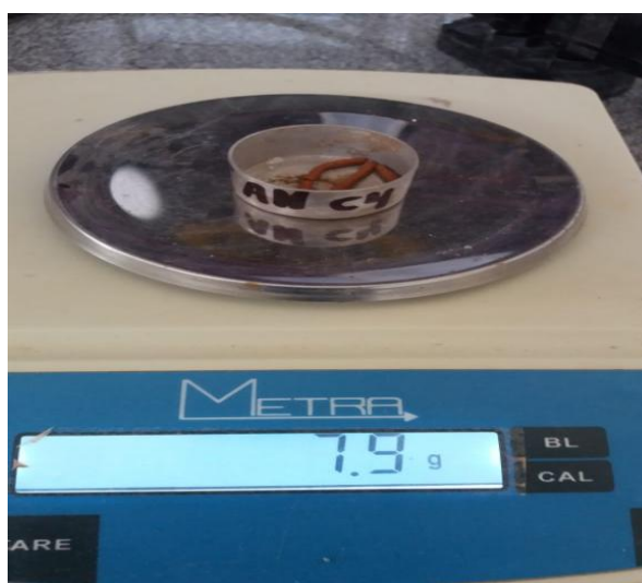
IMAGEM 29: Pesagem das cápsulas após secagem na estufa
