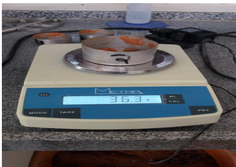
IMAGEM 24: Pesagem das amostras após secagem na estufa
