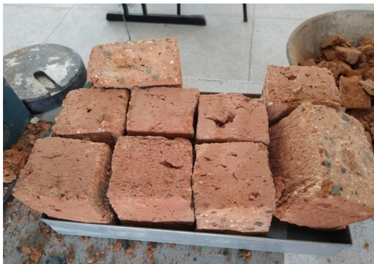
IMAGEM 34: Corpos de prova em cubo extraídos dos tijolos
