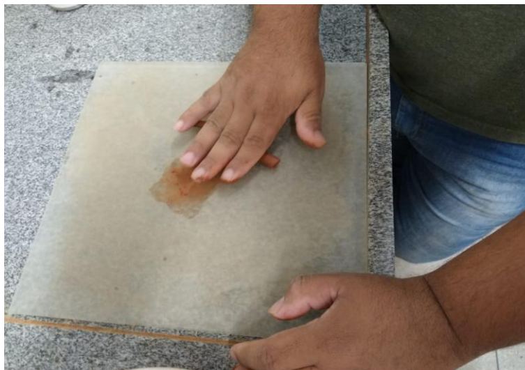
IMAGEM 26: Rolamento da amostra de solo na placa de vidro
