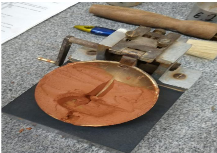
IMAGEM 21: Amostra de solo retirado no ponto de união da ranhura
