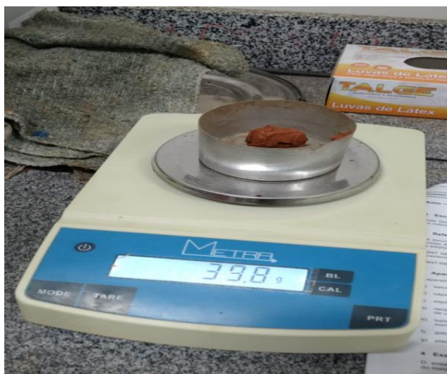
IMAGEM 22: Pesagem das amostras extraídas do aparelho de Casagrande
