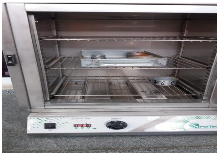
IMAGEM 23: Cápsulas sendo colocadas na estufa
