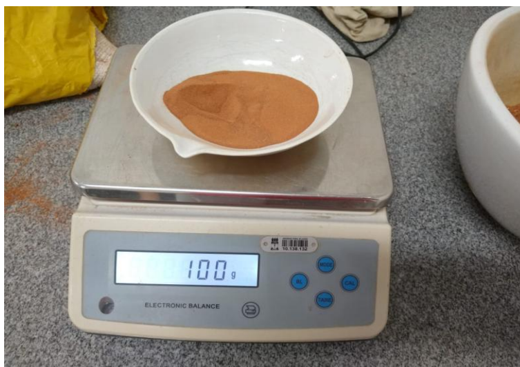
IMAGEM 15: Amostra de solo usado no ensaio do Limite de Liquidez
