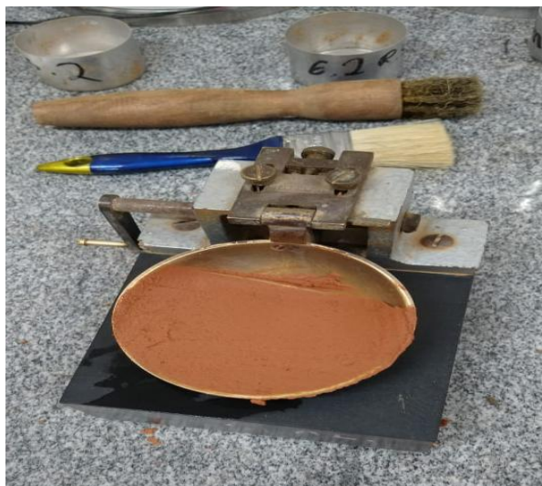
IMAGEM 18: Moldagem do solo no aparelho de Casagrande
