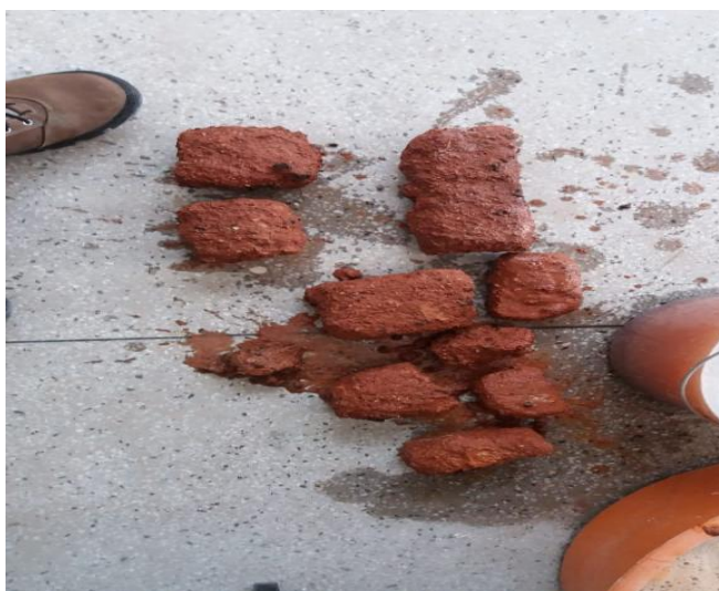
IMAGEM 39: Tijolos após 24 horas de imersão em água
