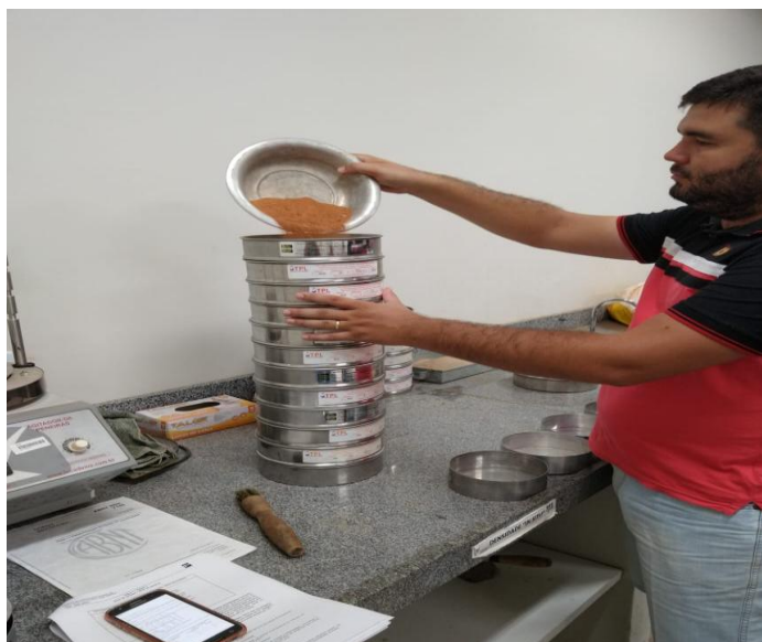
IMAGEM 13: Início do ensaio de Granulometria com adição do solo no jogo de peneiras
