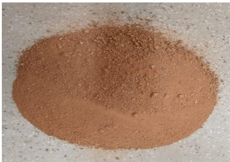
IMAGEM 09: Amostra de solo após o processo de destorroamento
