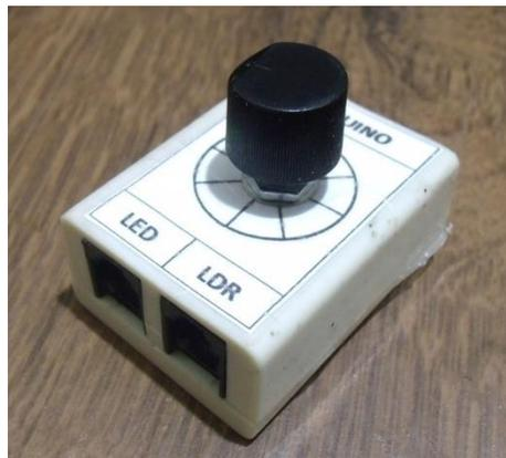
O LDR e o LED foram colocados no suporte para que as medições possam ser realizadas, sendo assim, tivemos que construir dois cabos com conectores RJ11 Machos para plugar os sensores ao circuito. Os dados capturados pelo Arduino são dispostos na porta paralela pelo software de aquisição de dados como já havíamos mencionado no experimento de espectroscopia. Seguiremos descrevendo o funcionamento do software de controle.
