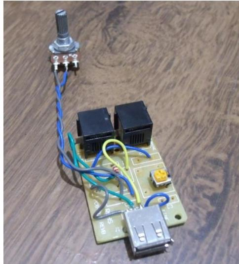
Os conectores utilizados na extensão telefônica eram do tipo RJ11 e foram reaproveitados para a nova montagem, além disso, a caixa que comportava o circuito foi reaproveitada para que o sistema ficasse bem acondicionado (Figura 03). Uma das saídas foi redimensionada para comportar o conector USB Fêmea que por meio de um cabo USB leva os dados até o Arduino.
