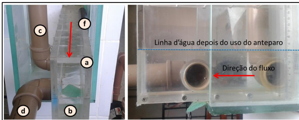
Figura 9 – Local do sensor (c), Barologger, (f), canal (a), adução (d), e anteparo (b).
