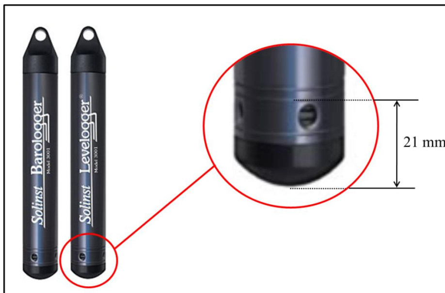
Figura 12 – Identificação do ponto em que o sensor de nível registra o nível d'água.
