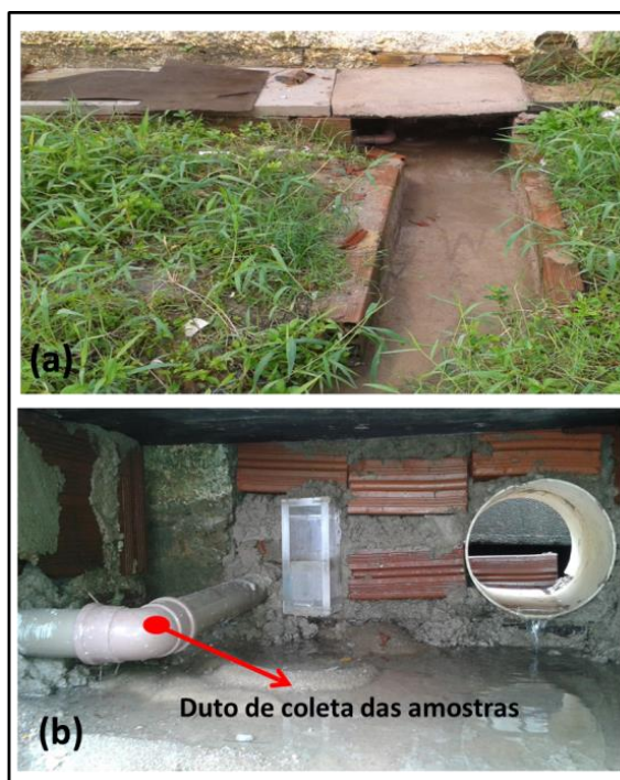
Figura 16 – Placas de proteção para o canal (b) e para as amostras (a)
