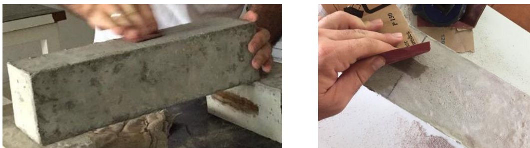
Figura 5.2 – Preparo da superfície do corpo de prova para colagem do extensômetro
