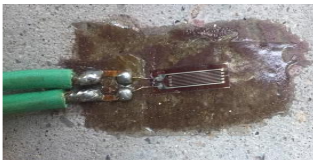
Figura 5.4 – Aspecto final do sensor após a soldagem dos terminais
