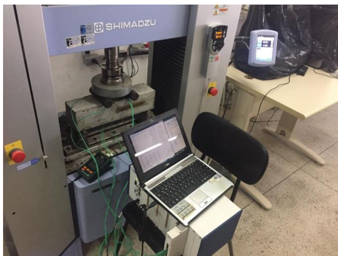
Figura 5.6 – Realização do ensaio de 4 pontos e o aparato utilizado
