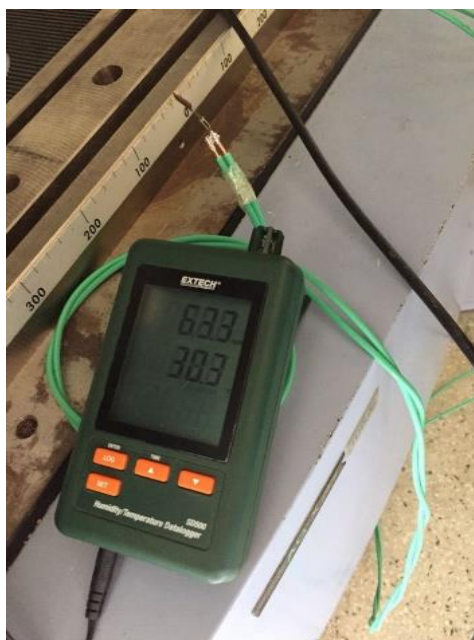
Figura 5.7 – Termo higrômetro utilizado para registro da temperatura
