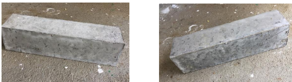
Figura 5.1 – Corpos de Prova recém desmoldados
