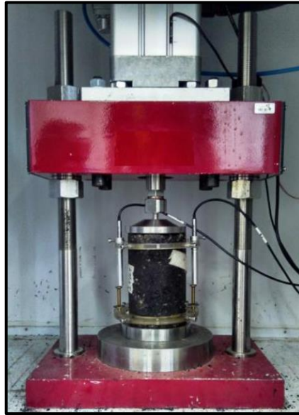
Figura 4.20 - Esquema de montagem do ensaio de Flow Number (FN)
