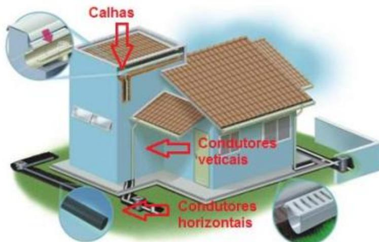
Figura 3 - Detalhe dos dispositivos de condução de água pluvial (fonte: TIGRE, 2008).
