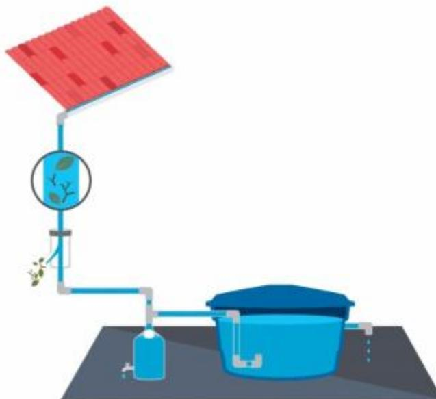
**Figura 1 – Esquema de um sistema de captação de águas pluviais (fonte: IPT, 2015)**
