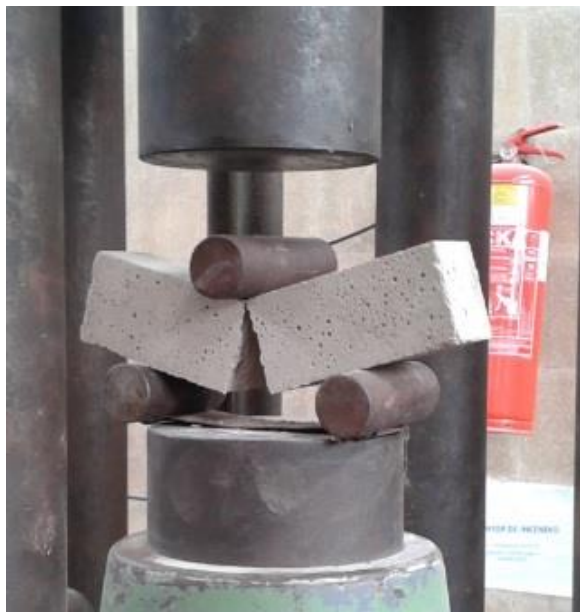
Figura 5.11 – Corpo de prova rompido à tração na flexão.
