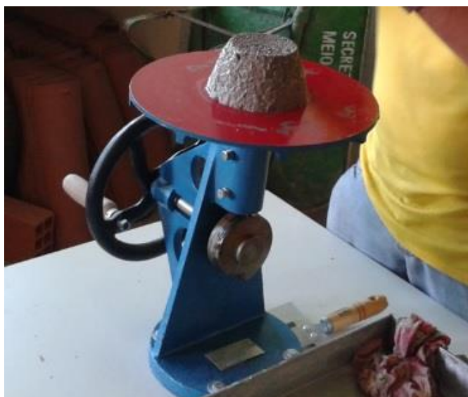
Figura 5.5 – Argamassa imediatamente após a retirada do molde tronco-cônico.
