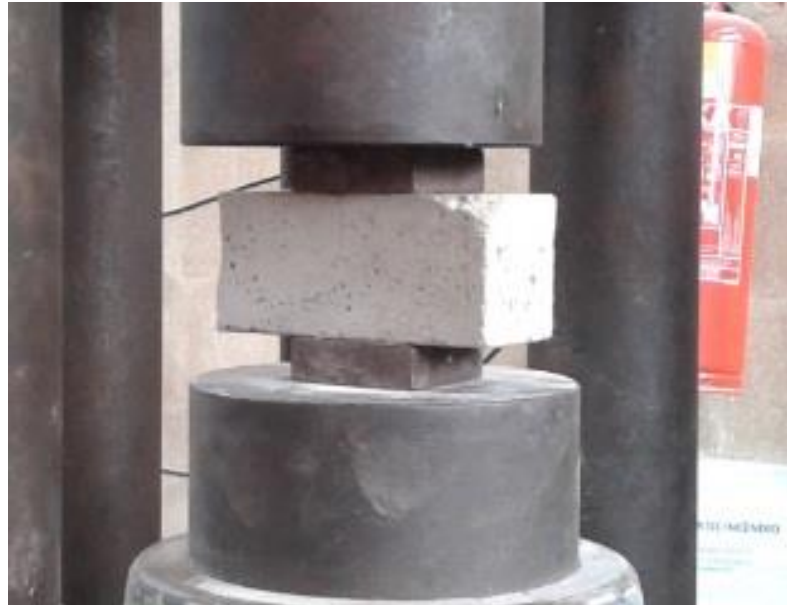
Figura 5.13 – Ensaio de resistência à compressão.
