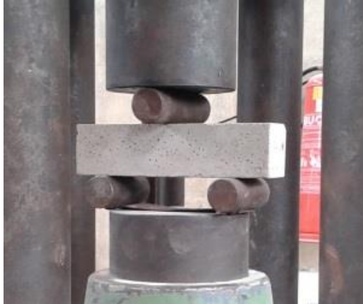
Figura 5.10 – Ensaio de resistência à tração.
