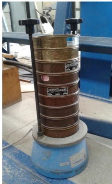
Figura 5.1 – Conjunto de peneiras utilizado na determinação da granulométrica.
