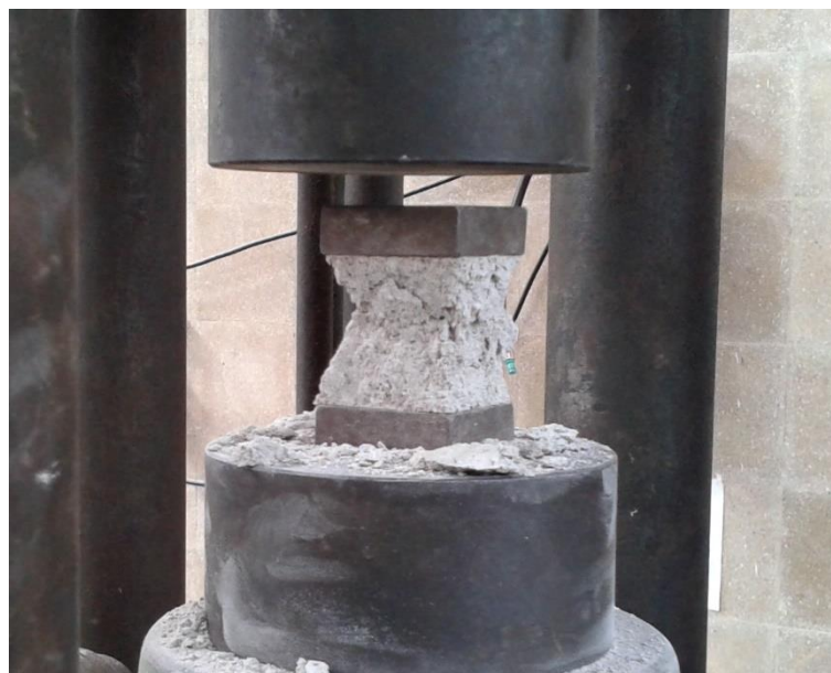
Figura 5.14 – Corpo de prova rompido à compressão.
