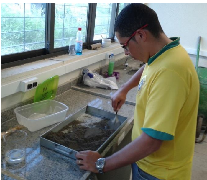
Figura 5.3 – Argamassa sendo preparada.
