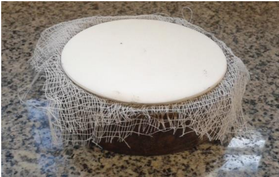
Figura 5.7 – Molde preenchido com argamassa, telas de gaze e discos de papel filtro.
