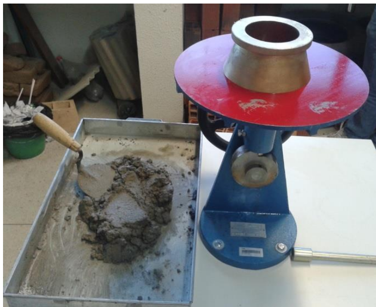
Figura 5.4 – Equipamentos e argamassa para determinação do índice de consistência.
