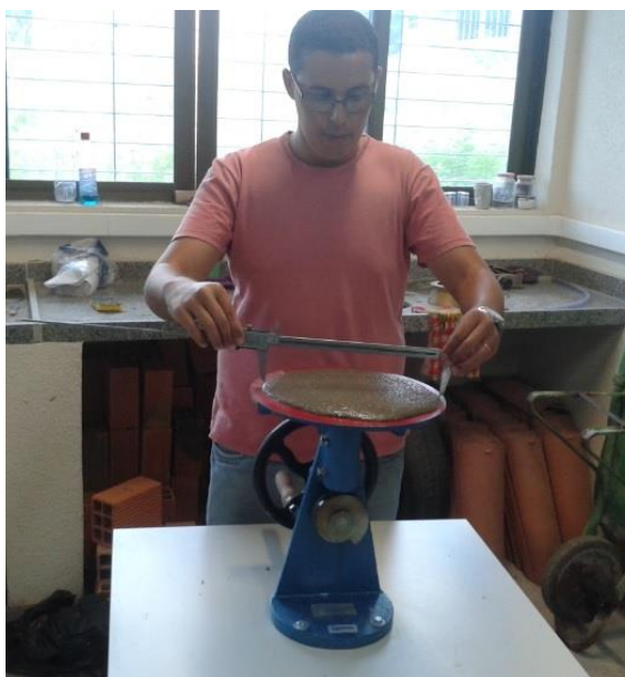
Figura 5.6 – Medição dos diâmetros referentes ao espalhamento da argamassa.
