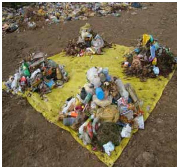
Figura 11 - Determinação da composição gravimétrica
