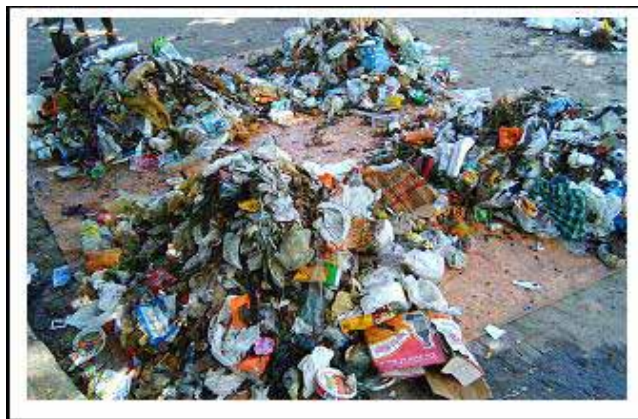
FIGURA 10. Divisão da amostra em 4 partes, com aproximadamente 100kg cada.
