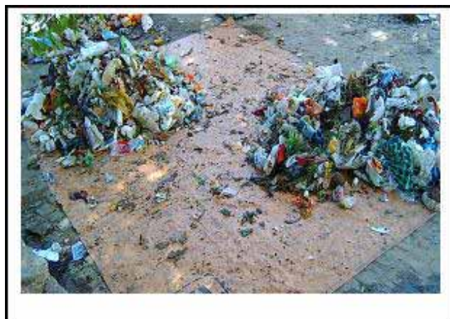
FIGURA 11. Primeiro quarteamento, retirada de duas partes restando 200kg.
