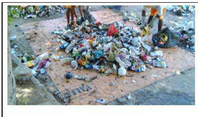
FIGURA 12. Mistura das duas partes do primeiro quarteamento, cerca de 200kg.
