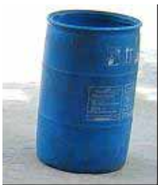
FIGURA 7. Recipiente adotado para determinação do peso específico.
