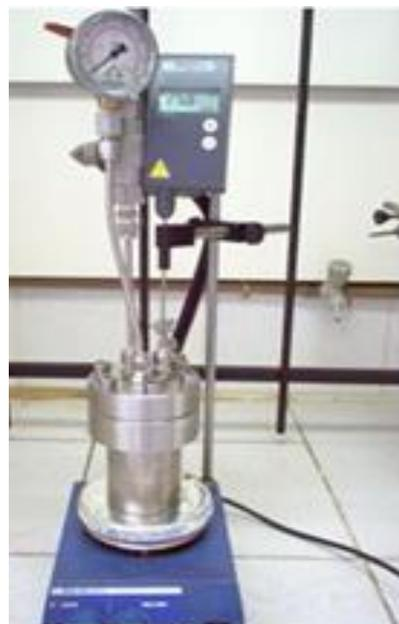
**Figura 15:** Reator de aço inoxidável RP
