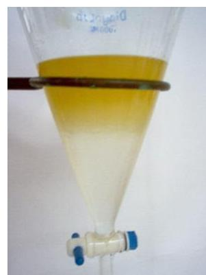
**Figura 35:** Eliminação do HCl
