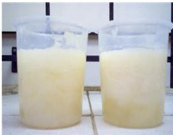
**Figura 32:** Sabão obtido da saponificação do óleo de soja
