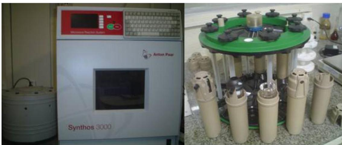
**Figura 16:** Reator microondas Synthos 3000, base giratórias e tubos de quartzo.
