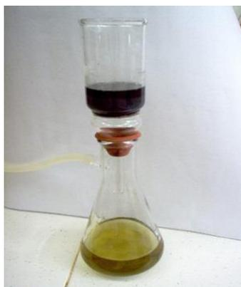
**Figura 38:** Separação do ácido graxo e o carvão ativado, com auxílio de um funil sinterizado
