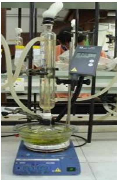
**Figura 14:** Reator de vidro acoplado a um condensador de refluxo RVCR
