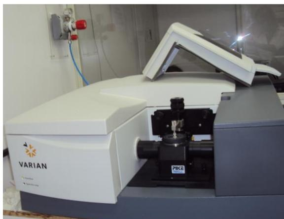
**Figura 11:** Espectrofotômetro de infravermelho por Transformada de Fourier
