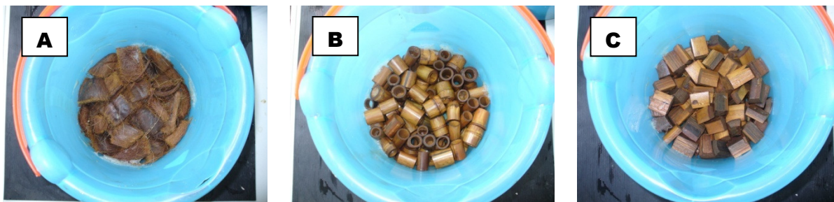
Figura 4.3 – Reatores com os suportes utilizados nos experimentos (A: coco , B: caniço , C: guadua ).
