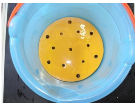
Figura 4.4 – Vista superior de reator contendo suporte com um disco de plástico perfurado.
