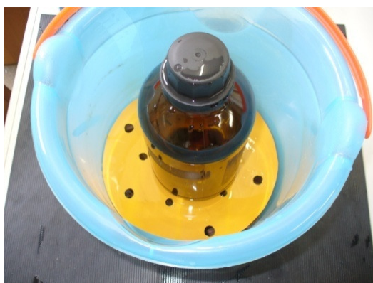
Figura 4.5 – Reator utilizado nos experimentos, com disco plástico perfurado e frasco de vidro para manutenção dos suportes submersos.
