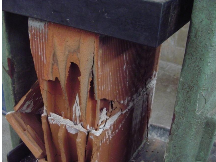
Figura 3.22 - Exemplo de um prisma 150.10 após ruptura.
