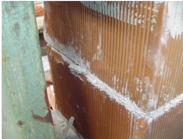
Figura 3.17 - Exemplo de um prisma 50.15 após ruptura.
