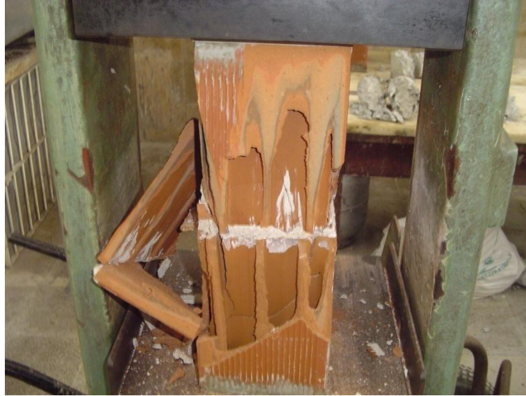
Figura 3.23 - Exemplo de um prisma 150.15 após ruptura.
