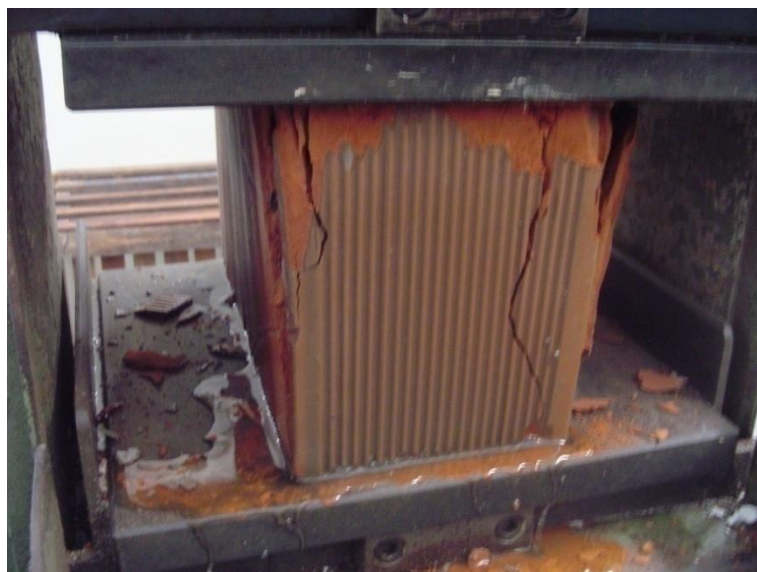
Figura 3.5 - Bloco cerâmico ensaiado até ruptura.
