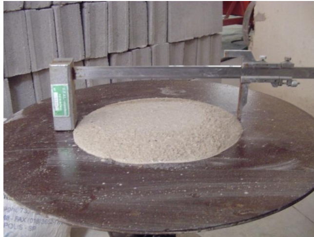
Figura 3.7 - Medição dos diâmetros de espalhamento da argamassa.
