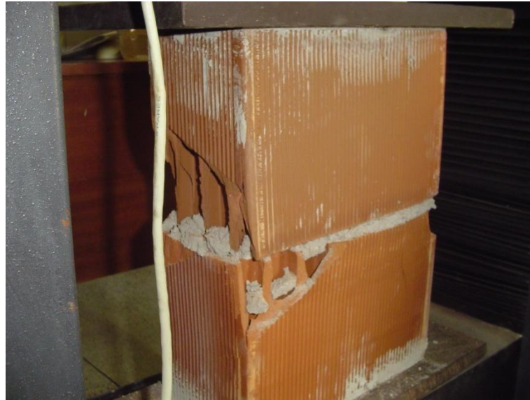
Figura 3.19 Exemplo de um prisma 100.10 após ruptura.
