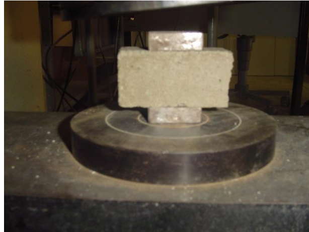
Figura 3.10 – Ensaio de compressão da argamassa
