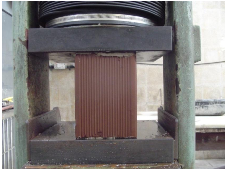
Figura 3.4 - Bloco cerâmico na prensa durante ensaio.
