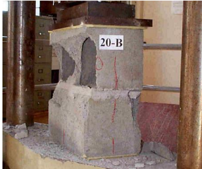
Figura 2.7 - Prisma ensaiado por MORENO JR. & ALBUQUERQUE (2002).
