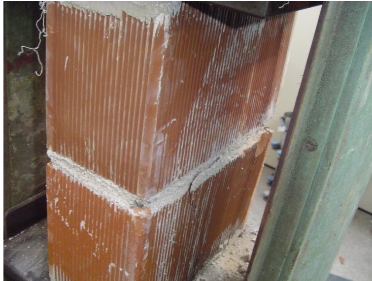
Figura 3.18 - Exemplo de um prisma 50.20 após ruptura.
