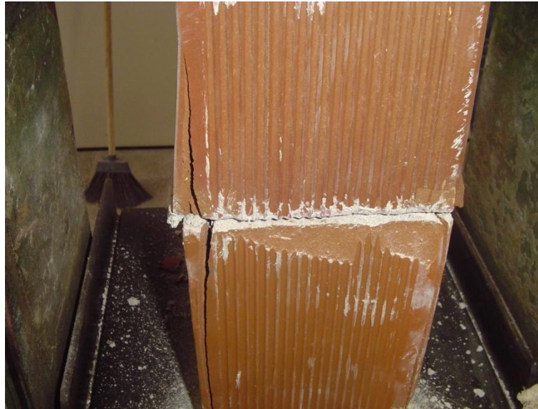
Figura 3.16 - Exemplo de um prisma 50.10 após ruptura.
