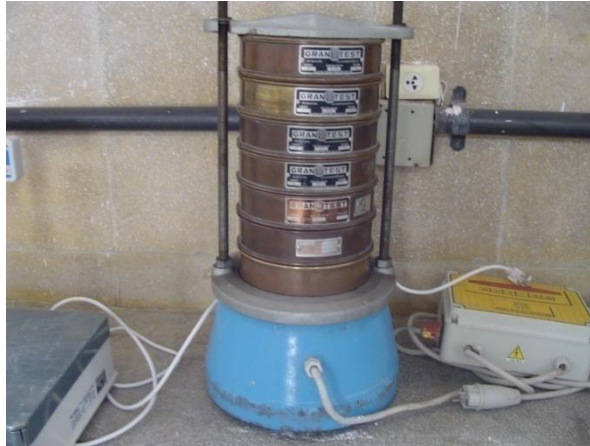
Figura 3.6 - Determinação da composição granulométrica da areia.
