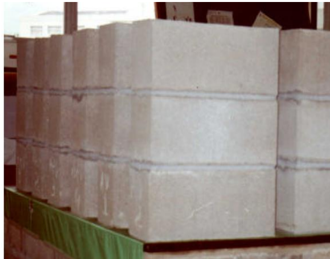
Figura 2.4 - Prismas ensaiados por STEIL (2003)
