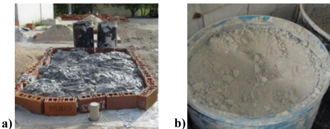
Figura 3.3 – a) Secagem ao sol do resíduo recém-coletado; e b) resíduo estocado em tonéis após secagem (Fonte: LISBÔA, 2004).
