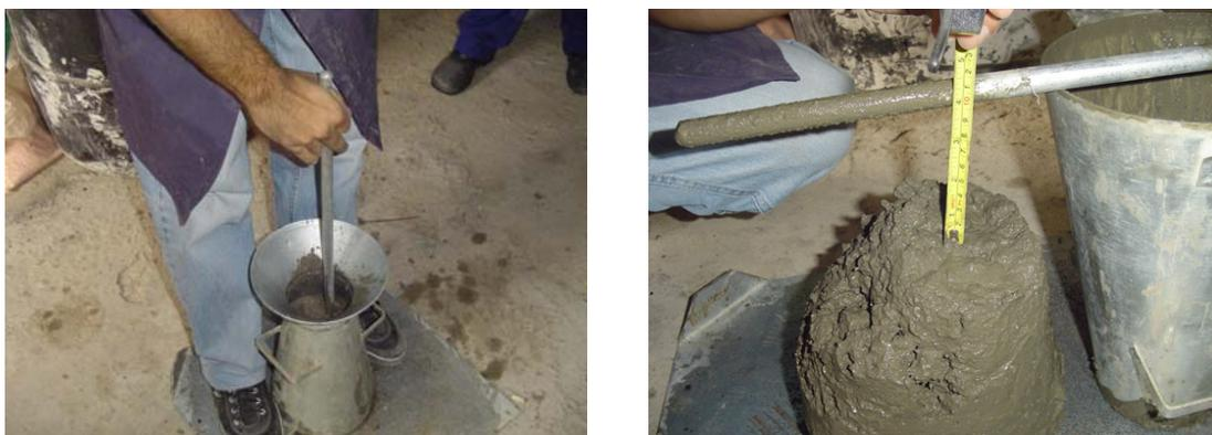
Figura 3.11 – Execução do ensaio de abatimento.
