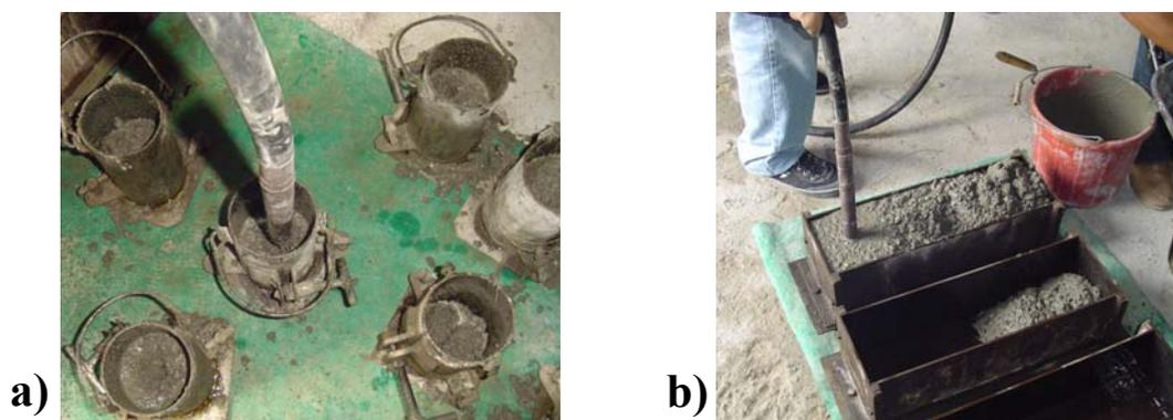
Figura 3.19 – Moldagem com concretos adensados por vibração:
