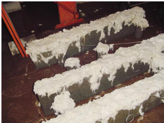
Figura 3.21 – Cura das vigas por molhagem.
