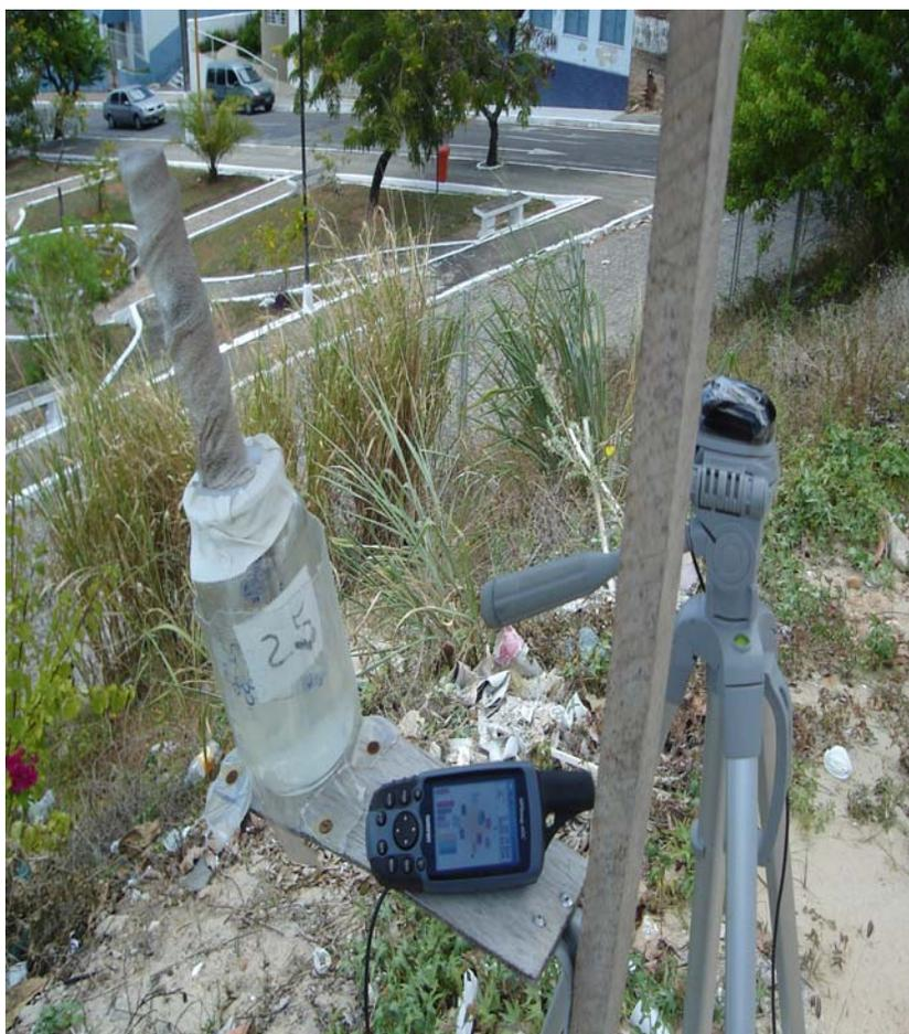
Figura 19: Vela úmida geo-referenciada em campo.
