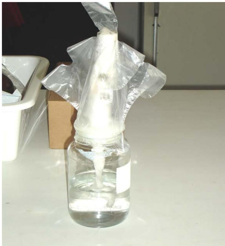
Figura 16: Vela úmida montada e protegida para exposição.
