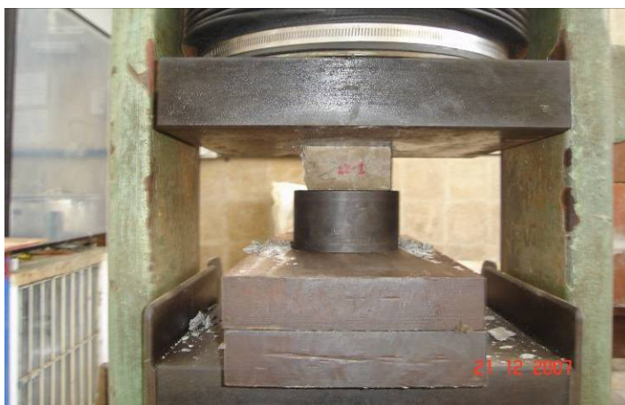
Figura 5.25 – Ruptura à compressão utilizando parte do corpo-de-prova do ensaio de flexão.
