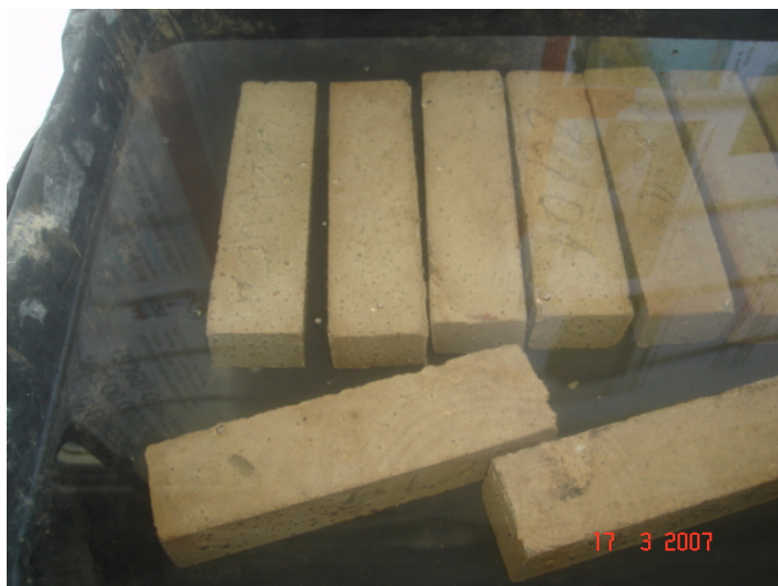
Figura 4.23 – Corpos-de-prova do ensaio de ataque por sulfatos.
