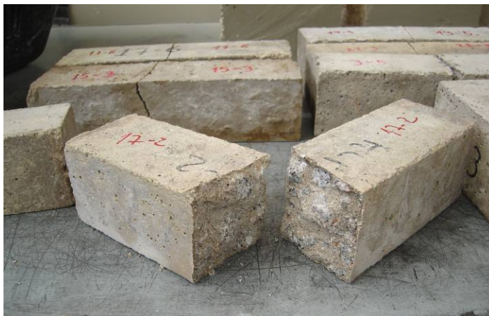
Figura 5.24 – Corpo-de-prova após a ruptura à flexão.
