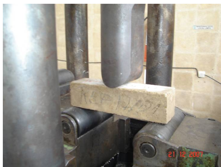
Figura 5.23 – Ruptura à flexão dos corpos-de-prova.
