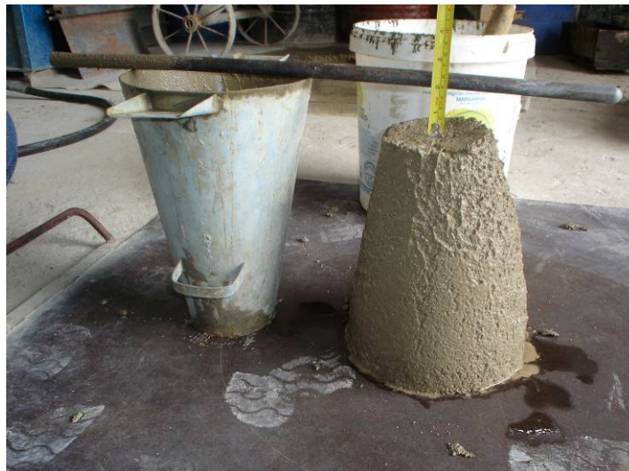
Figura 5.1 – C-I-COMP após o ensaio de abatimento de tronco de cone.
