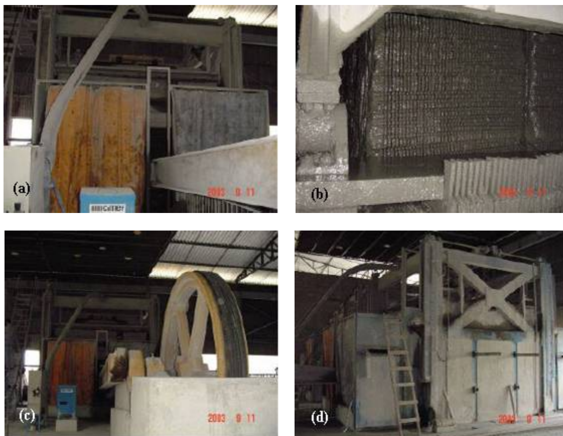
Figura 4.2 – (a) Vista frontal da entrada dos teares; (b) Bloco na saída dos teares já desdobrado em chapas; (c) Parte mecânica dos teares; (d) Vista lateral dos teares (LISBÔA, 2004).
