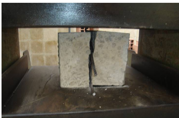
Figura 5.11 – Fratura do corpo-de-prova para aplicação da fenolftaleína.
