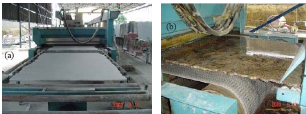
Figura 4.3 – (a) Processo de corte das chapa brutas; (b) Processo de polimento das chapas (LISBÔA, 2004).
