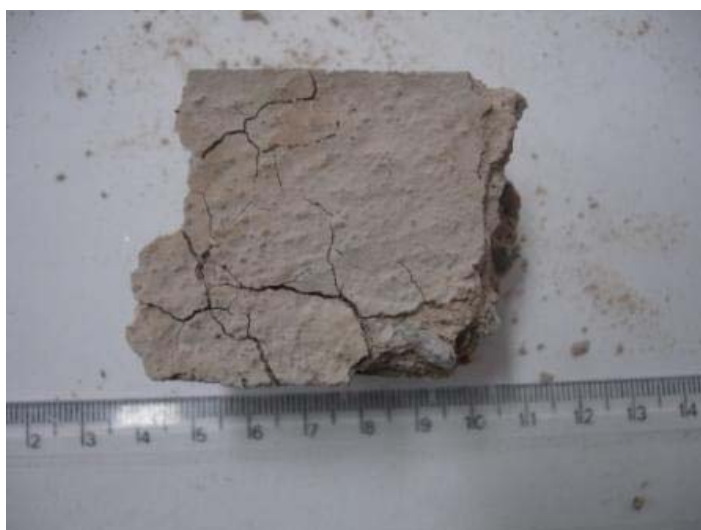
Figura 5.31 – Aspecto do C-I-COMP após a ruína por ataque de sulfatos.
