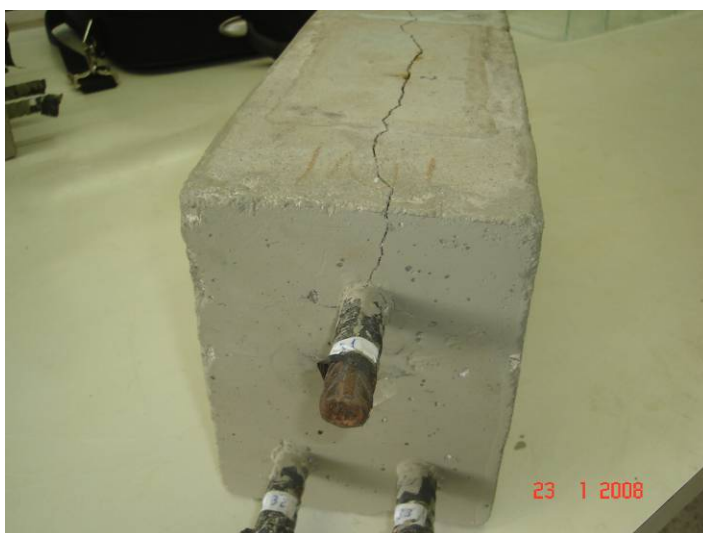
Figura 5.40 – Corpo-de-prova após o encerramento do ensaio, observe-se a propagação da fissura até o encontro com a barra.
