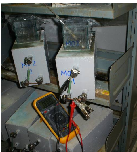
Figura 4.20 – Esquema do ensaio de potencial de corrosão.
