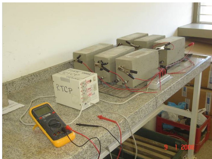
Figura 4.21 – Esquema geral do ensaio de corrente impressa.
