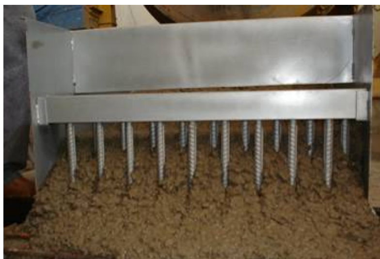
Figura 5.3 – Teste de bloqueio adaptado para o concreto auto-adensável.
