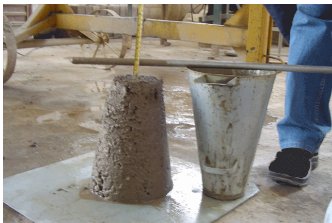
Figura 4.9 – Ensaio do abatimento do tronco de cone para concretos convencionais.
