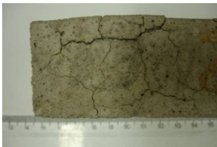
Figura 5.29 – Aspecto do CAA-RCMG após a ruína por ataque de sulfatos.
