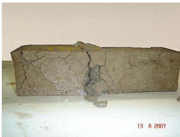
Figura 5.18 – Corpo-de-prova submetido ao ataque mais agressivo, rompido manualmente à flexão após a ruína.
