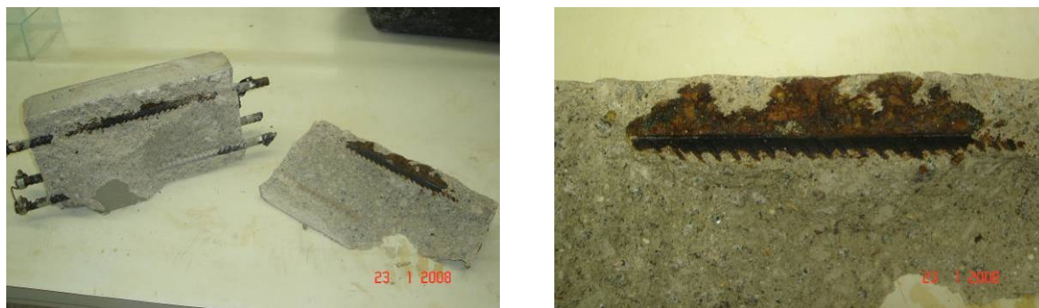
Figura 5.41 – Corpo-de-prova rompido para retirada do ânodo, observe-se a impregnação de produtos de corrosão no concreto adjacente à barra.
