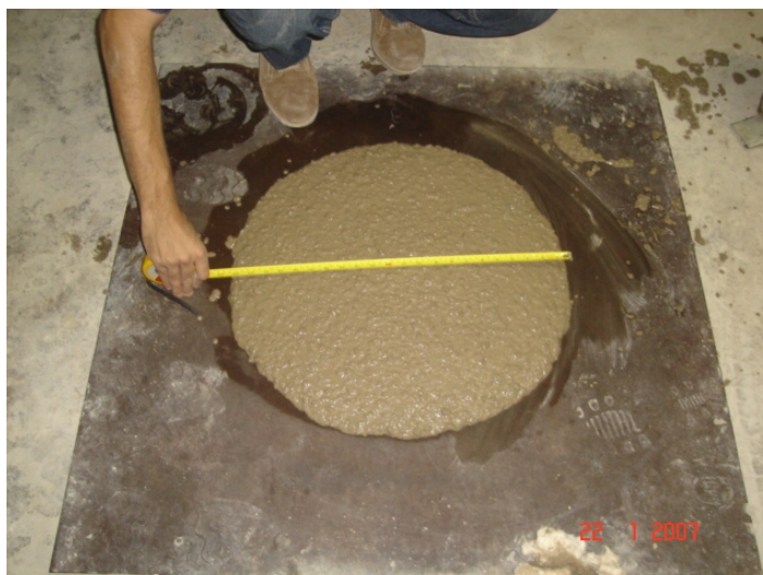
Figura 5.2 – CAA-RCMG após o espalhamento.
