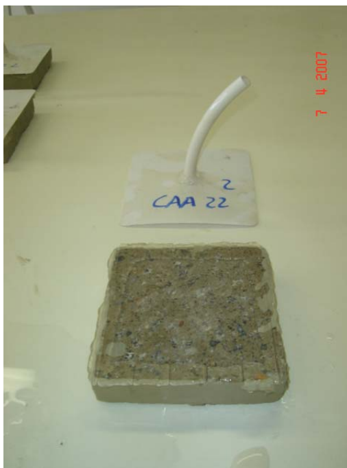
Figura 5.9 – Corpo-de-prova do ensaio de absorção por sucção capilar, após a execução do ensaio.
