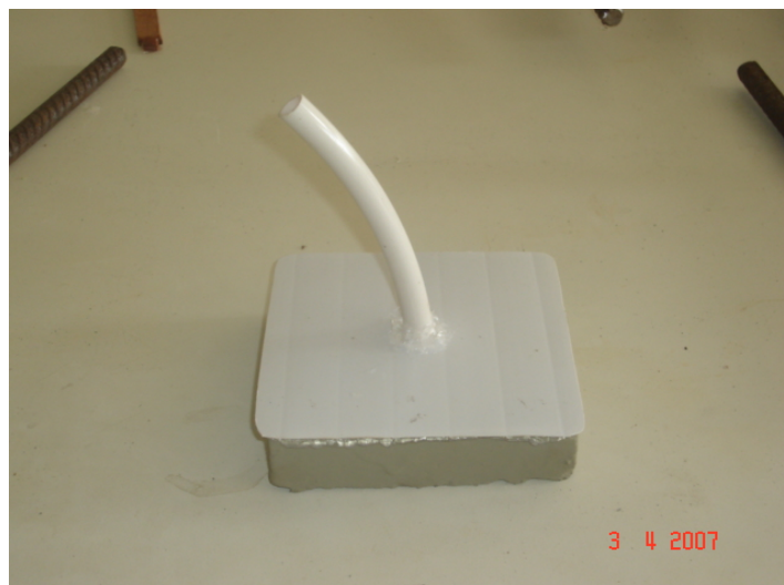
Figura 4.13 – Corpo-de-prova com placa de PVC posicionada.
