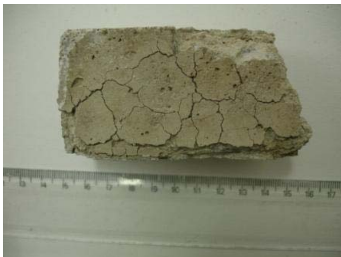
Figura 5.30 – Aspecto do C-REF após a ruína por ataque de sulfatos.
