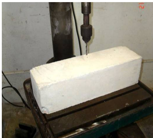
Figura 4.15 – Detalhe da execução dos furos no concreto com furadeira de bancada.
