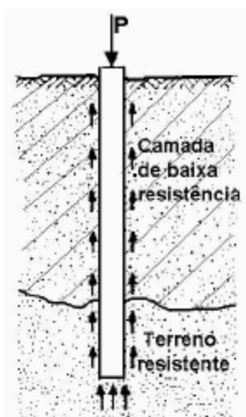
Figura 03. Mecanismos de resistência da fundação profunda
