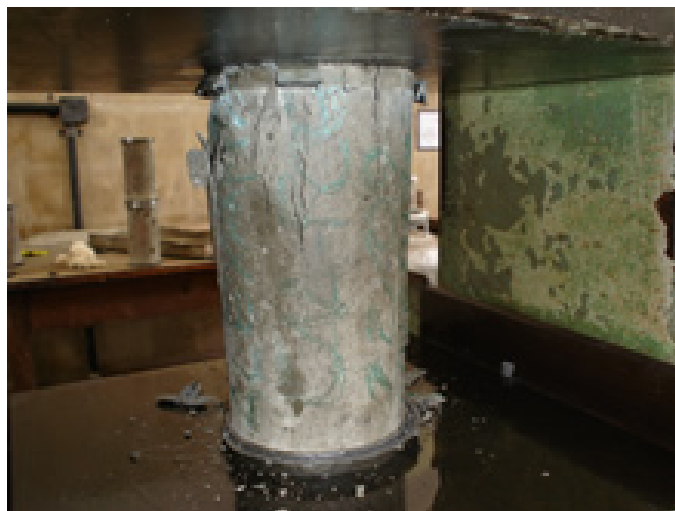
Figura 36 – Ensaio de resistência à compressão.
