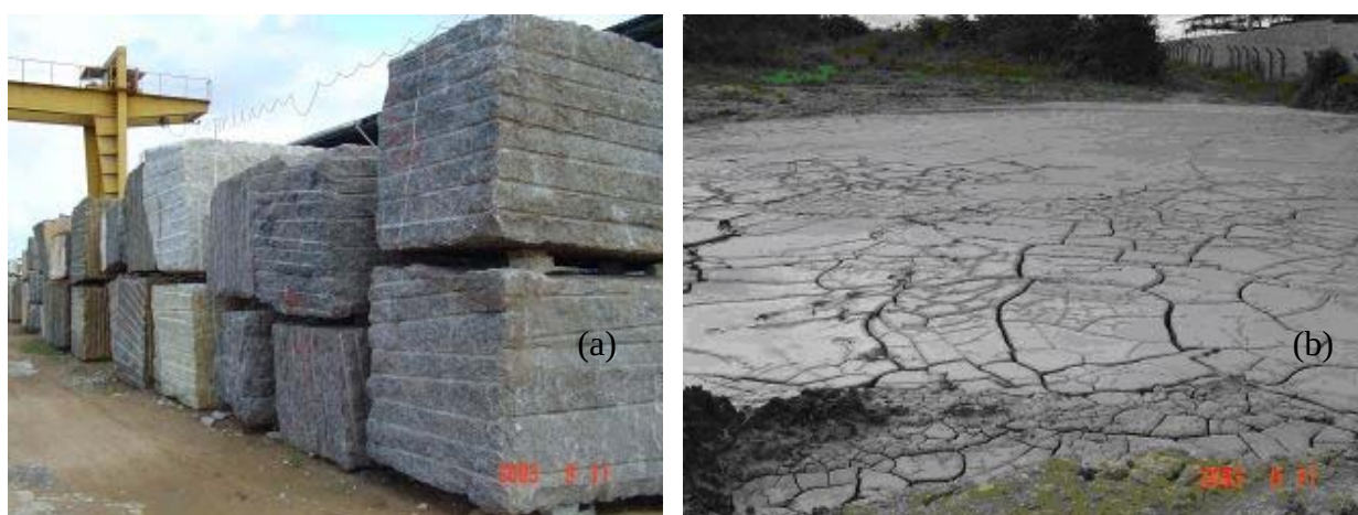
Figura 01 (a) – Blocos de pedras graníticas (b) – Lama do RSMG à céu aberto.
