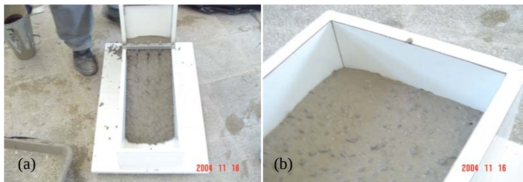
Figura 51 (a) e (b) - Execução do ensaio da Caixa L (L-Box).
