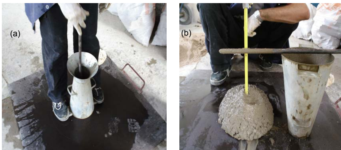
Figura 54 – Ilustração do abatimento no cone de Abrams para o concreto convencional.
