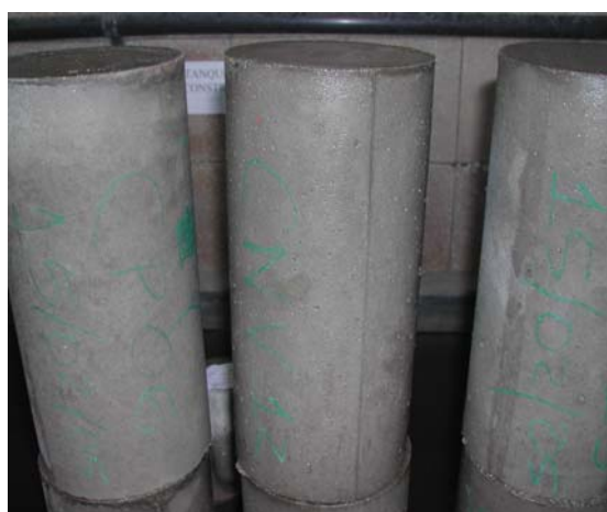
Figura 55 – Aspecto visual do c.p. 15 cm x 30 cm moldado com o CAA não vibrado.
