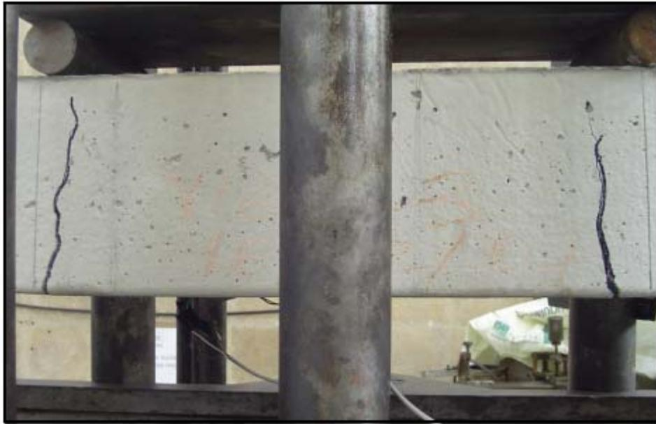
Figura 5.3 - Abertura da 2ª fissura - abertura aproximada de 0,4 mm. Carga de ruptura
