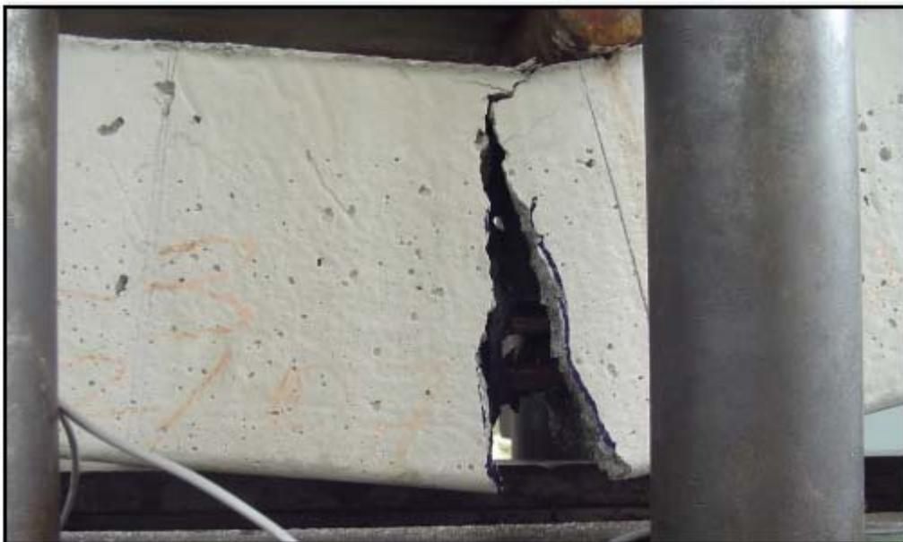
Figura 5.4 - Destruição completa da viga para verificação da posição do reforço
