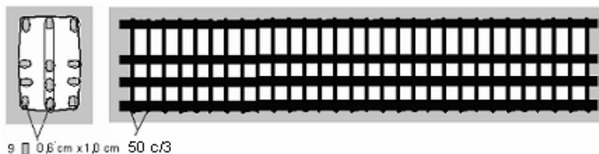
Figura 4.6 – Detalhamento da viga do exemplo 1 – Corte transversal e longitudinal
