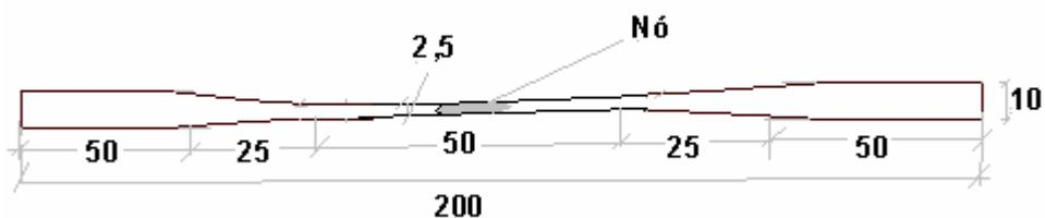
Figura 3.6 – Vista frontal do corpo-de-prova com medidas em mm (INBAR, 1999).
