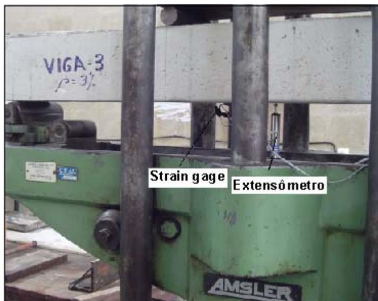
Figura 5.1 - Viga instrumentada para o ensaio à flexão pura.
