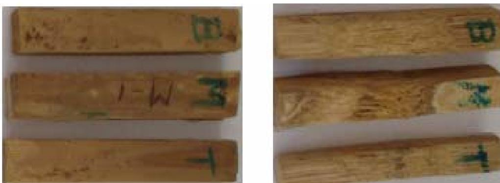
Figura 3.4 – Amostras para determinação do teor de umidade e da densidade.
