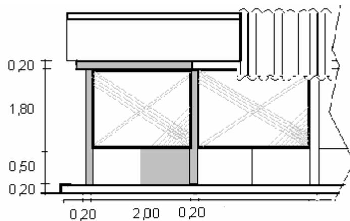
Figura 6.6 - Detalhe da aplicação de vigas, colunas e placas de concreto com reforço de bambu, em galpões de instalações rurais
