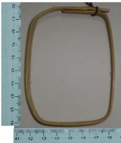
Figura 3.10 – Detalhe do estribo de bambu de 6 cm x 9 cm, usados nas vigas 1, 2, 3 e 3.1
