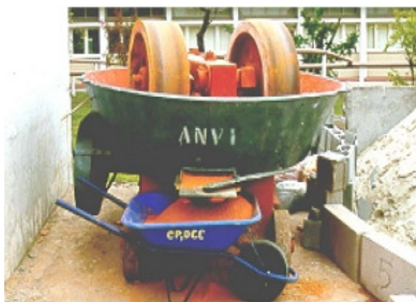
Figura 2.6: Moinho-argamassadeira da marca ANVI (MIRANDA; SELMO, 2006).
