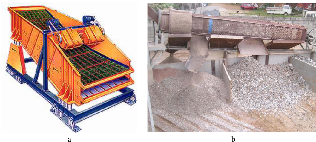
Figura 2.7: Peneiras (a) vibratória de uso industrial (www.mining-technology.com, 2006) e (b) trommel da usina de Gentil (SP) (LEVY, 2005).
