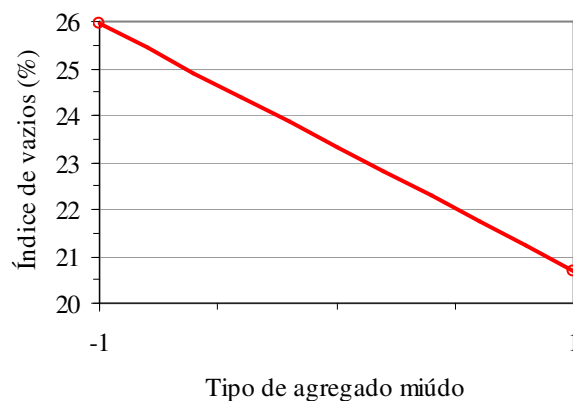
Figura 6.40: Efeito isolado do tipo de agregado miúdo sobre o índice de vazios (-1 = reciclado e +1 = areia).
