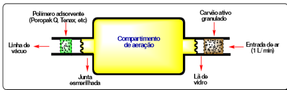
Figura 14 - Sistema de coleta de compostos voláteis
