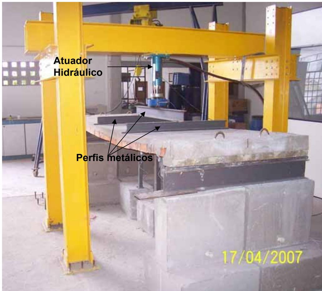
Figura 51 – Esquema de carregamento das lajes
