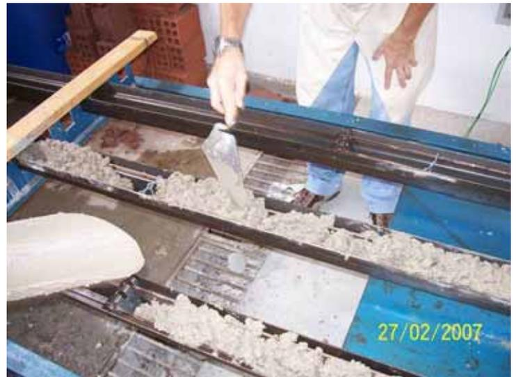
Figura 40 – Moldagem das vigotas.
