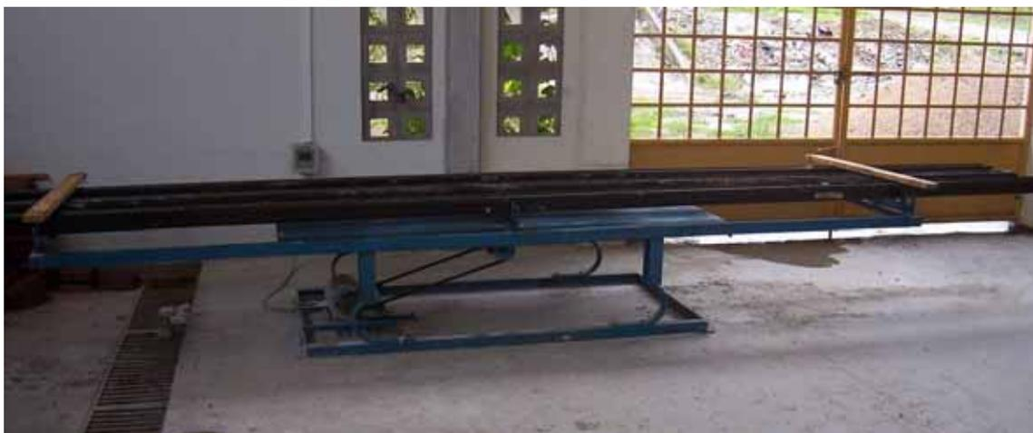
Figura 42 – Mesa vibratória utilizada para adensamento das vigotas
