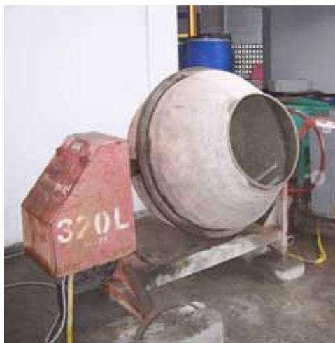
Figura 39 - Betoneira utilizada para a fabricação dos concretos
