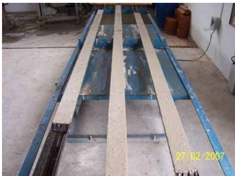
Figura 43 – Vigotas após a vibração
