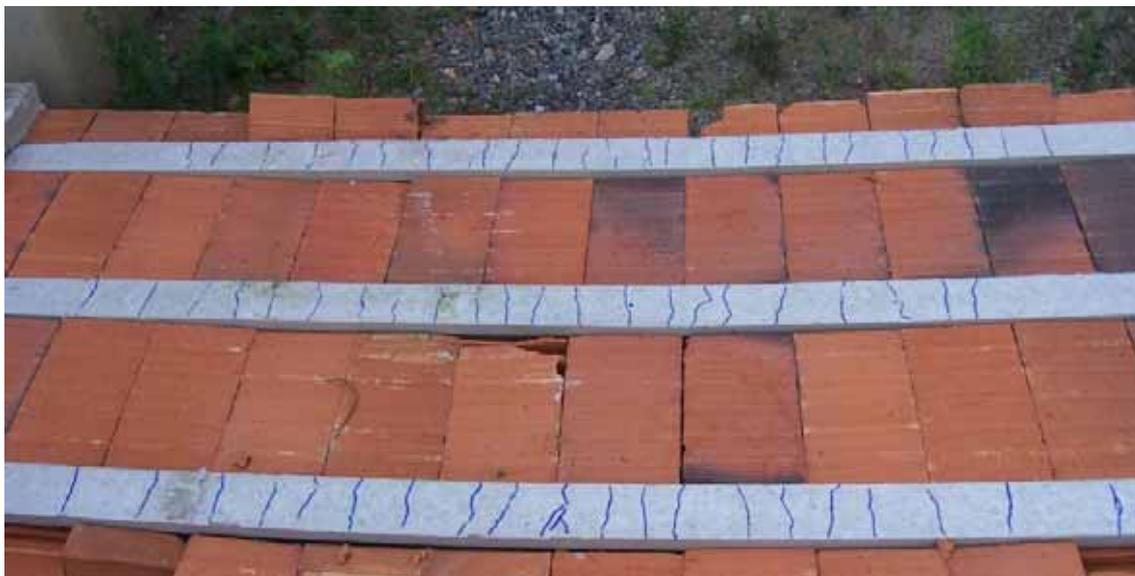
Figura 75 - Fotografia da laje RCD-100% fissurada
