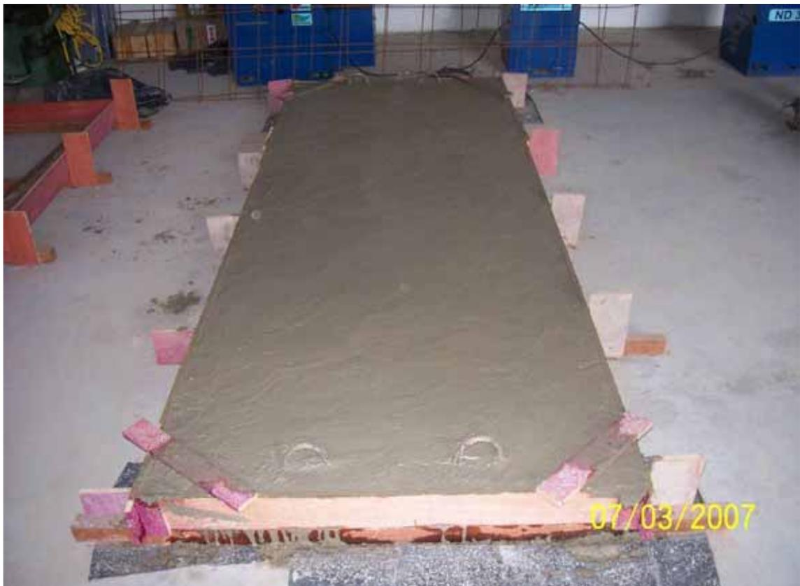
Figura 34 – Laje após a moldagem
