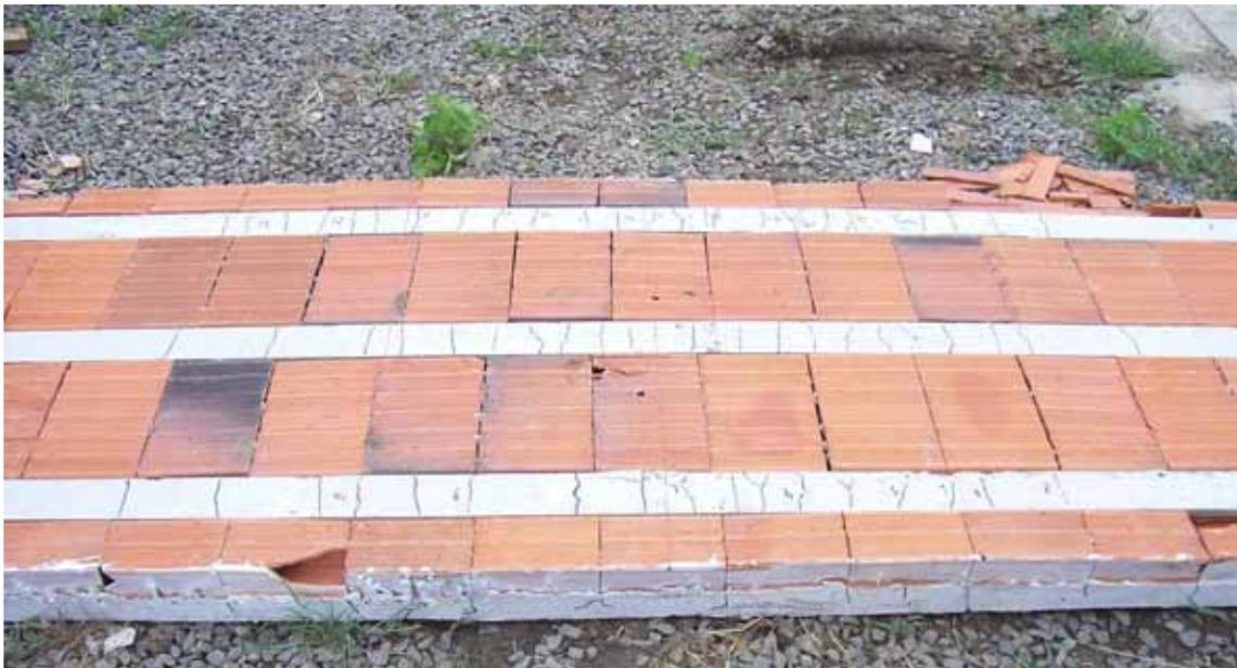
Figura 71 - Fotografia da laje de referência fissurada
