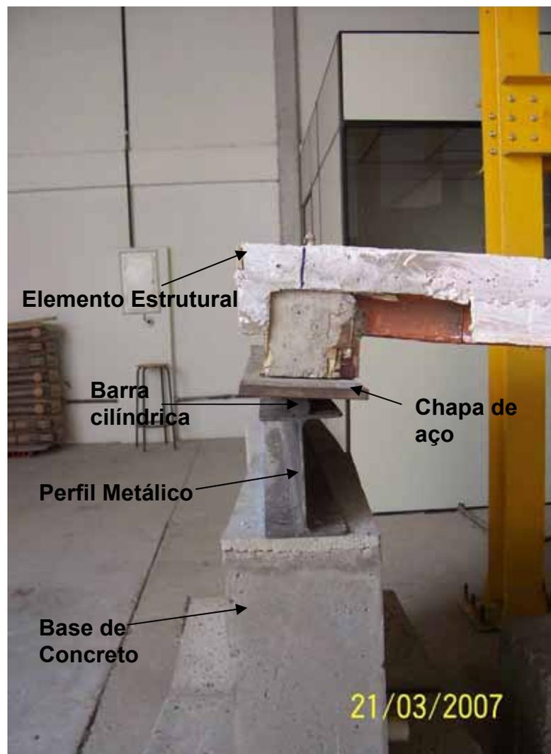
Figura 53 – Rotação do elemento estrutural no apoio
