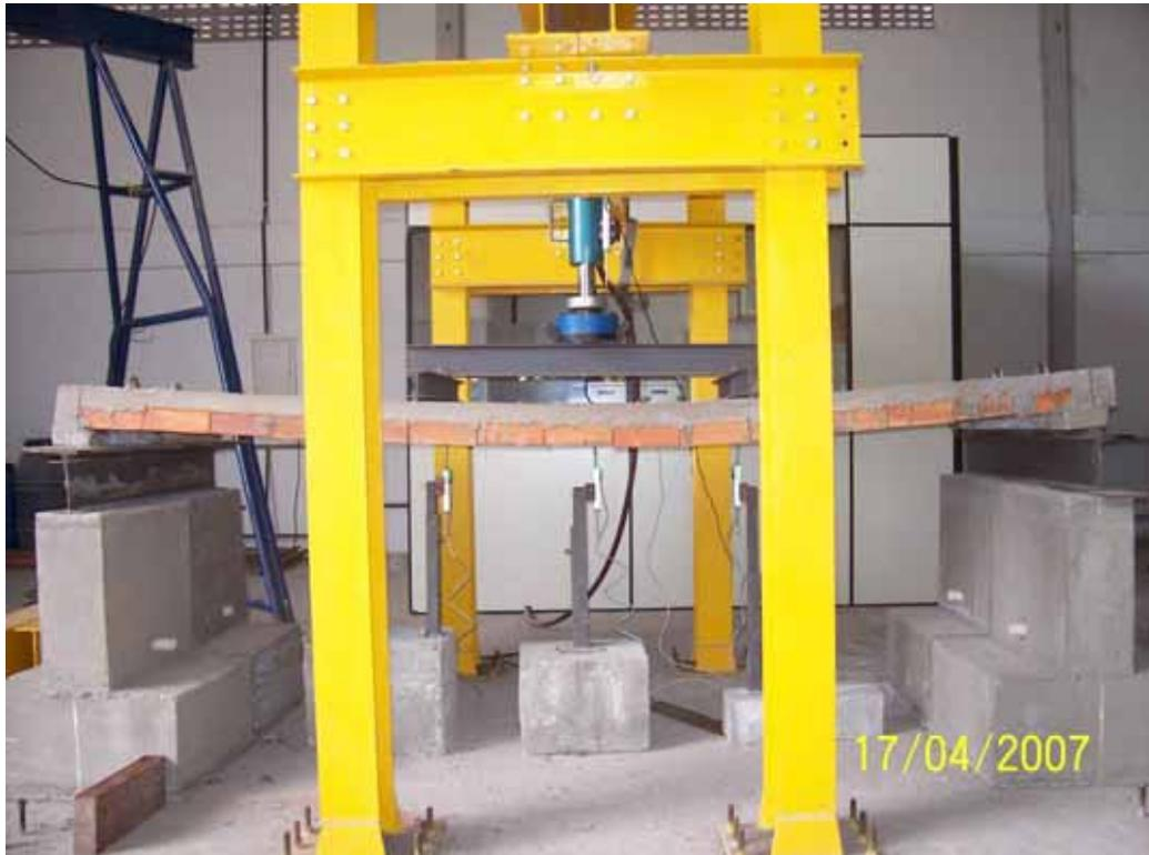
Figura 59 – Laje com deflexão excessiva
