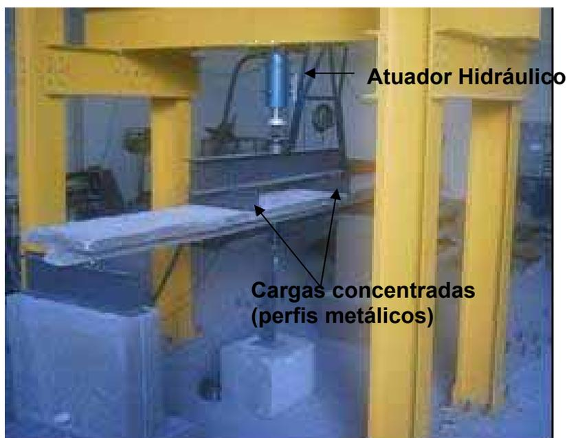
Figura 50 – Esquema de carregamento das vigas T
