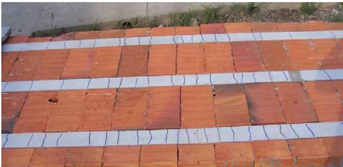
Figura 73 - Fotografia da laje RCD-50% fissurada
