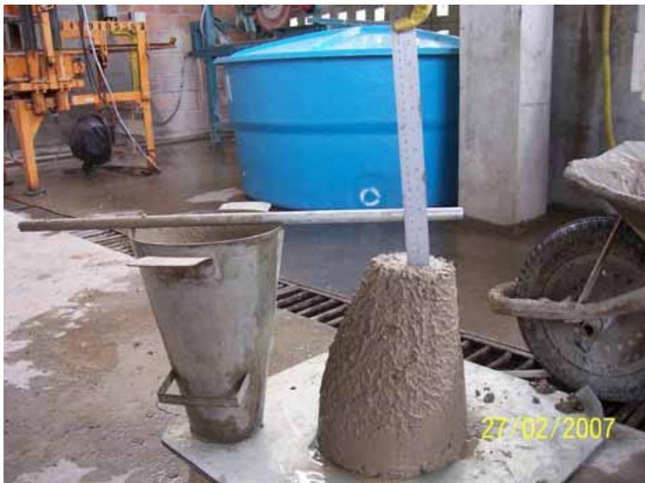
Figura 41 – Ensaio de abatimento de cone
