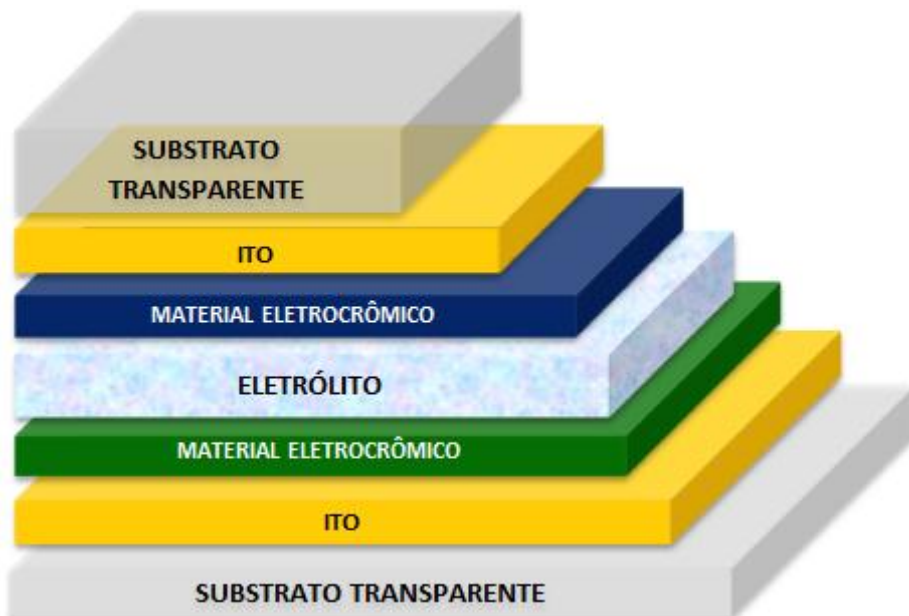
Figura 1 - Esquema representativo de um dispositivo eletrocrômico.
