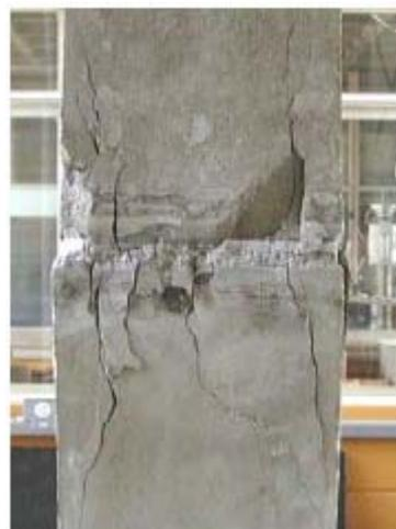
b – Modelo com almofada de apoio sem fibras
