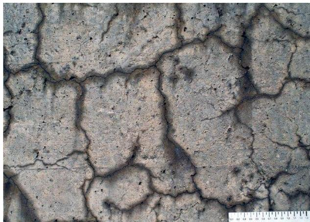
Figura 13 – Concreto sobre reação Álcali-agregado – Fonte: engenhariacivil.com, 2016
