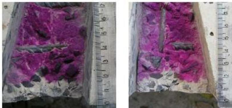
Figura 14 – Concreto carbonatado (teste com fenolftaleína) – Fonte: cimentoitambe.com.br, 2009
