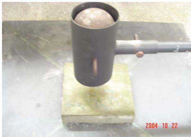
Figura 3.40 – Preparação do conjunto para início do ensaio.
