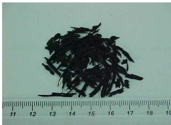
Figura 3.10 – Material retido na peneira de abertura 2,00 mm.
