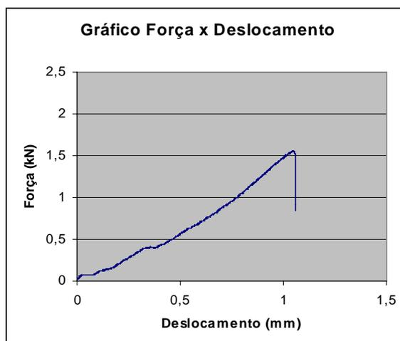
Figura 3.57 – Gráfico de flexão-deformação para o CAB.
