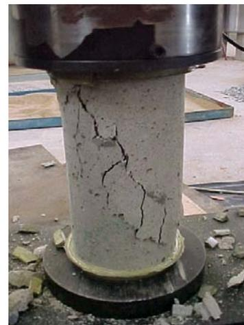
Figura 3.35 – Modo de ruptura do CAB.
