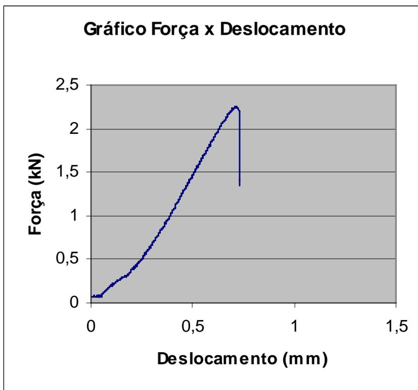
Figura G. 4 – Gráfico força x deslocamento, elemento 01.
