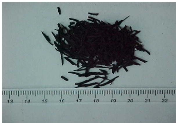
Figura 3.11 – Material retido na peneira de abertura 1,19 mm.
