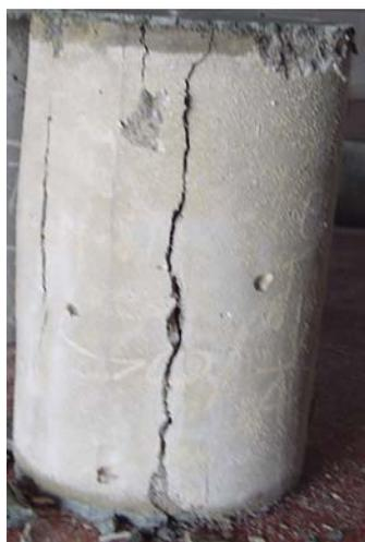
Figura 3.34 – Modo de ruptura do concreto de referência.
