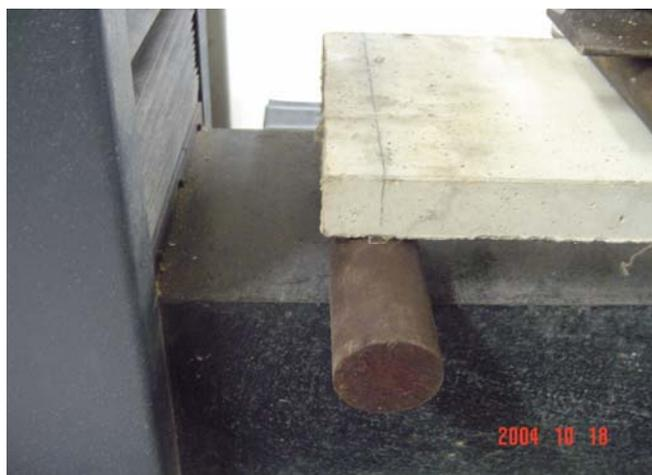
Figura 3.55 – Detalhe do apoio.
