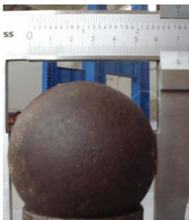
Figura 3.38 – Esfera de aço utilizada para provocar ensaio.
