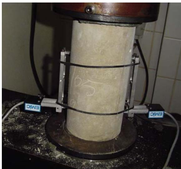
Figura 3.33 – Detalhe do ensaio de módulo.
