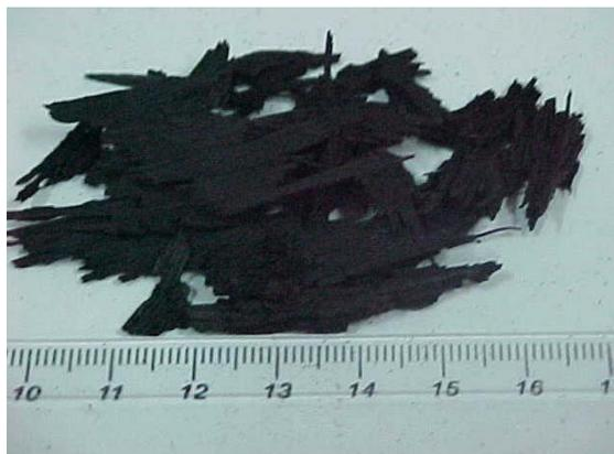
Figura 3.8 – Material retido na peneira de abertura 4,76 mm.
