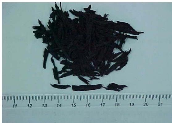
Figura 3.9 – Material retido na peneira de abertura 2,38 mm.
