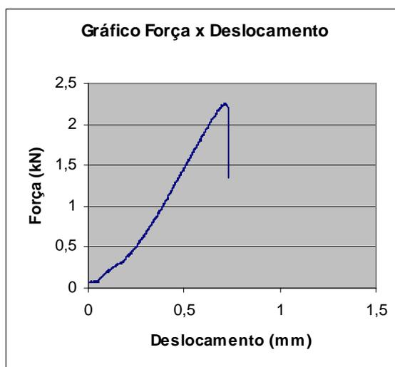
Figura 3.56 – Gráfico de flexão-deformação, concreto de referência.
