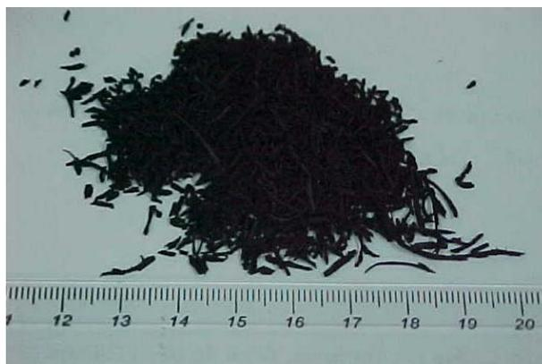
Figura 3.12 – Material retido na peneira de abertura 0,84 mm.
