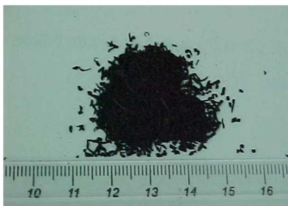
Figura 3.13 – Material retido na peneira de abertura 0,59 mm.
