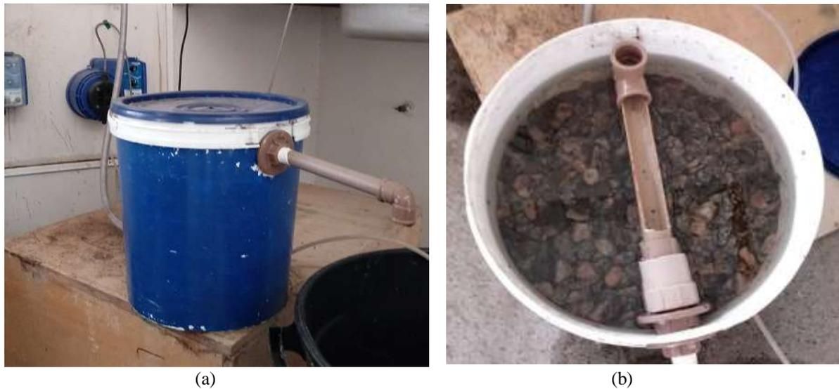
Figura 6 – (a) Filtro anaeróbio de fluxo ascendente. (b) Calha de coleta. (Fonte: Autor 2018).
