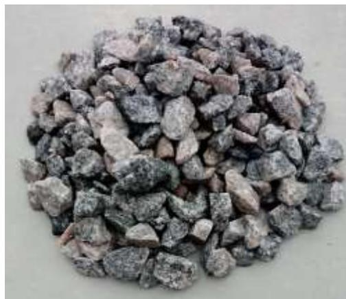
Figura 7 – Brita número 1 utilizada no filtro anaeróbio (Fonte: Autor 2017).
