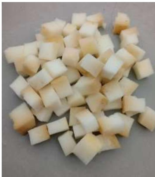
Figura 5 – Espuma de poliuretano cortada (Fonte Autor, 2018).
