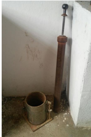
Figura 12 – Aparelhagem para Compactação
