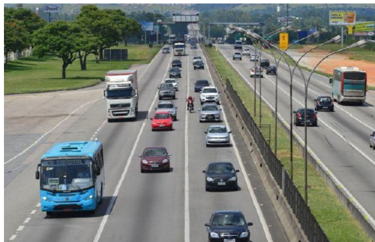
Figura 4: Exemplo de Rodovia com nível de serviço D
