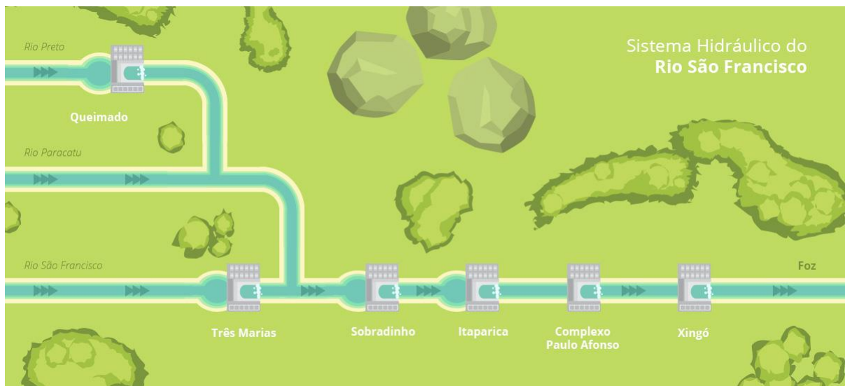
Figura 29 - Cascata de reservatórios na calha do rio São Francisco
