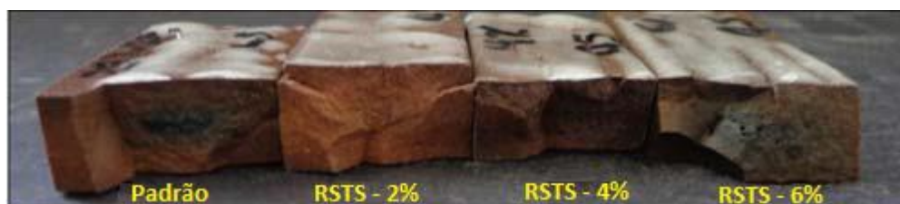
Figura 7. Imagem digital da tendência à formação de coração negro para Abs \leq 0,5\% .
