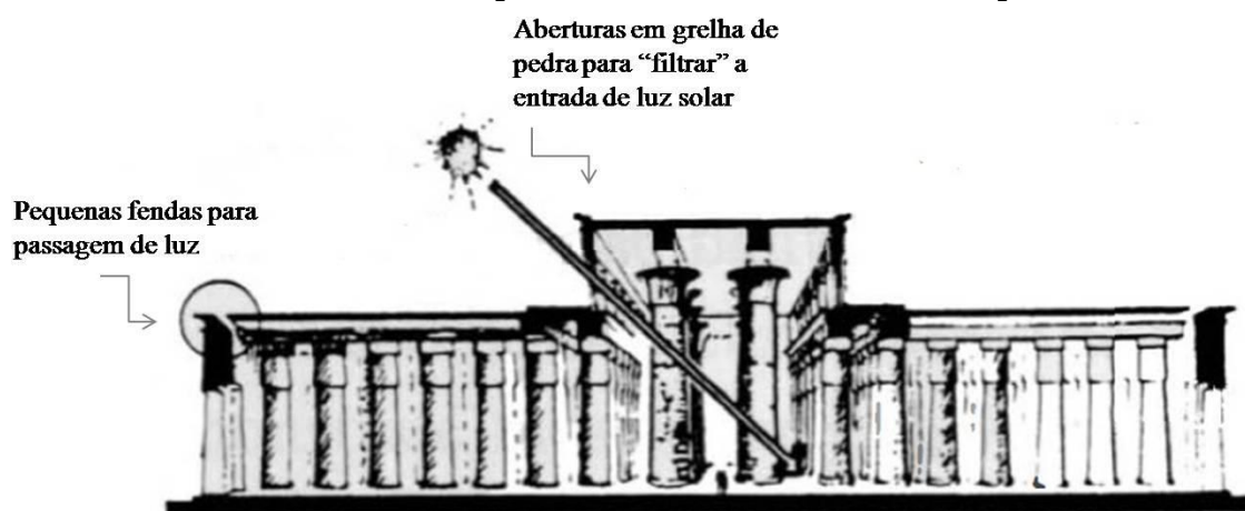
Figura 2 - Templo de Amun, Kamak, Egito. Seção indicando a forma pela qual a luz solar intensa é filtrada para o interior através de fendas de pedra
