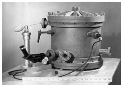
Figura 9 - Montagem utilizada por Millikan para sua investigação sobre a carga do elétron.
