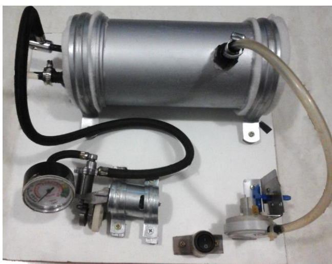
Figura 5 - Sistema para pulverização das gotículas de óleo no aparato de Millikan.
