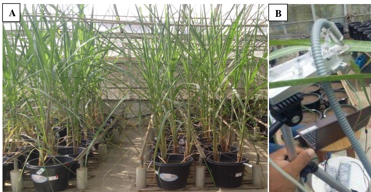
APÊNDICE 5. Vista parcial do experimento II com as plantas de cana-de-açúcar aos 90 dias após o plantio (A) e detalhe da câmara 2030-B acoplada na folha para avaliação da curva de luz (B), Rio Largo-AL, 2016.
