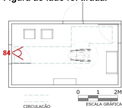
Figura 83- Áreas de circulação e manobra da Área de convivência 3 e indicação da posição em que a fotografia na Figura ao lado foi tirada.
