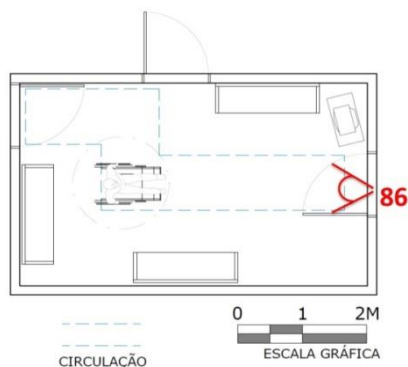
Figura 85- Áreas de circulação e manobra da Área de convivência 4 e indicação da posição em que a fotografia na Figura ao lado foi tirada.
